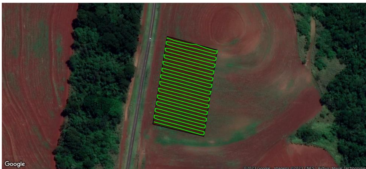
Figura 9 - Mapeamento da aplicação realizada pelo Drone Pelicano 2020, na área com dimensões retangulares. Botucatu, SP, 2023.
