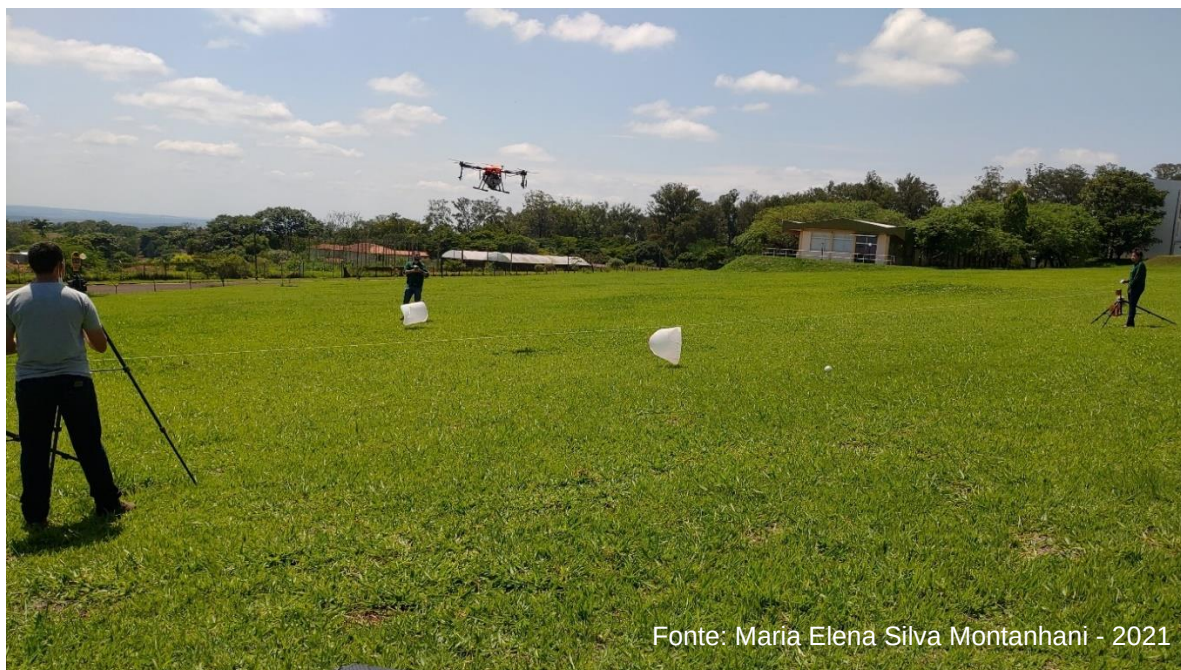
Figura 4 - Avaliação da faixa de deposição do drone pulverizador Pelicano 2020. Botucatu, SP, 2021.
