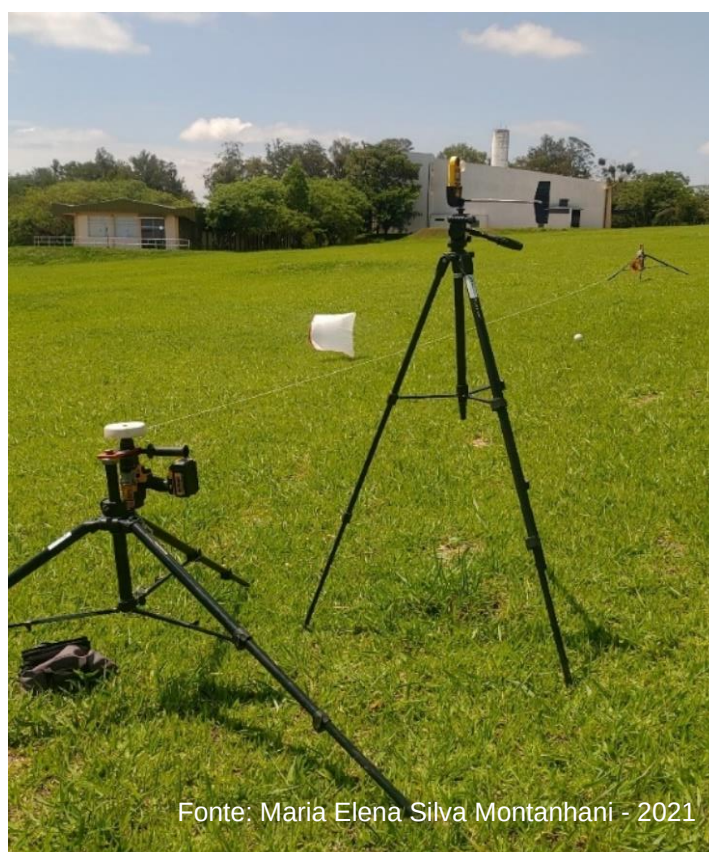
Figura 3 - Sistema de coleta de dados para a avaliação de faixa de deposição do drone pulverizador. Botucatu, SP, 2021.
