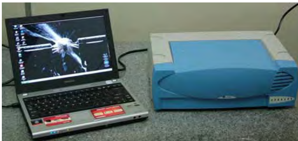
Figura 4 - b) Microcomputador ligado ao amplificador de sinais ADS 2000 IP (Lynxx São Paulo – Brasil).
