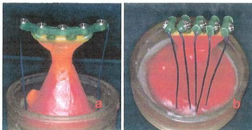
FIGURA 6 – Corpo-de-prova unido ao anel : a) monobloco; b) segmentos.
