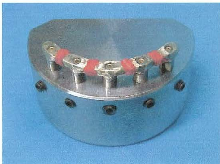
FIGURA 11 – União dos segmentos com resina.
