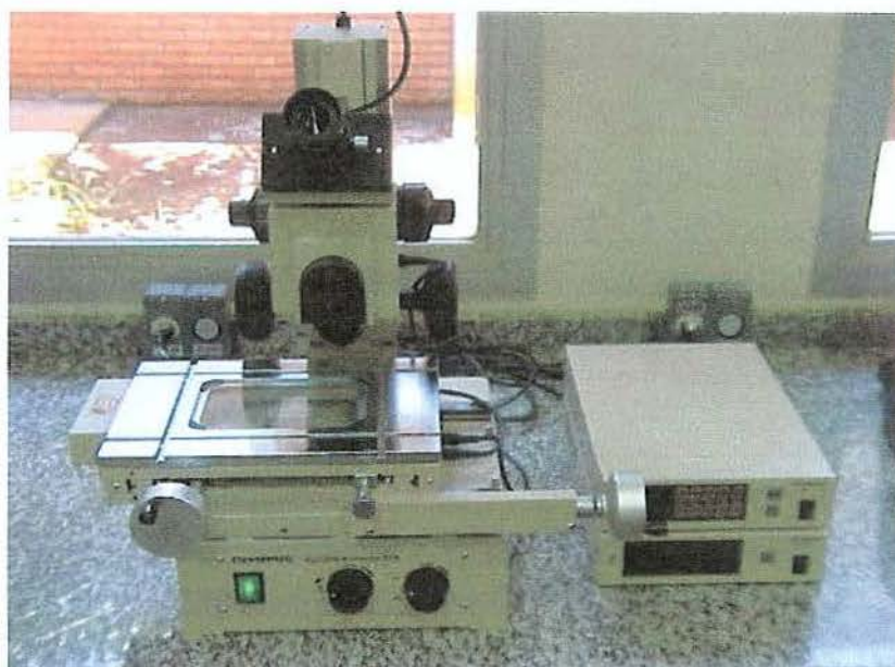
FIGURA 16 – Microscópio de medição digital.
