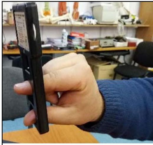
Figura 9 – Dinamômetro para teste de força da pinça
