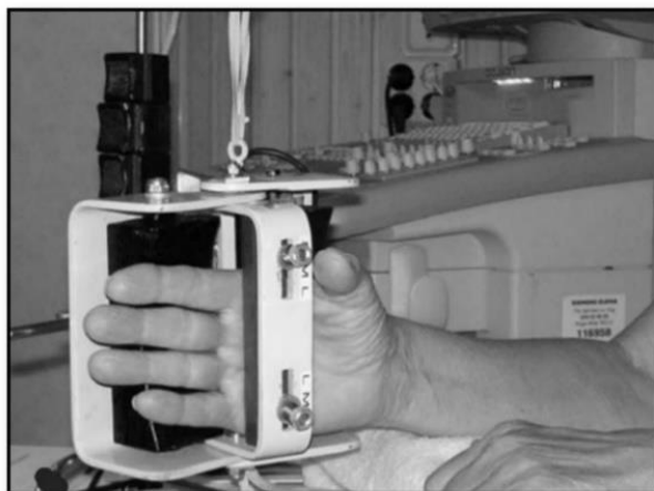
Figura 7 – Sistema de medição da extensão dos dedos
