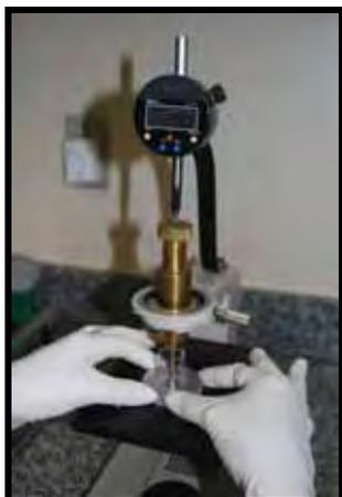
1. Bloco fixado em mandril para peça reta e montado em um microscópio modificado com um micrometro (Pantec, São Paulo, Brasil).
