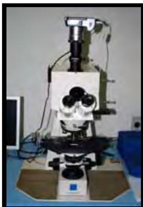
7. Microscópio de Luz Polarizada (AXIOPHOT - ZEISS DSM-940 A, Oberkochen, Germany) e câmera fotográfica digital (Canon, modelo Powershot A620) devidamente acoplada.
