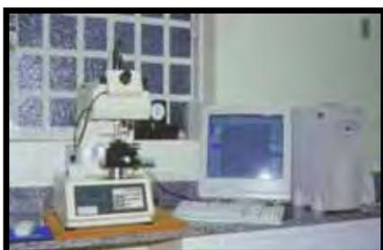
2. Microdurômetro Shimadzu Micro Hardness Tester HMV-2.000 (Shimadzu Corporation - Kyoto-Japan), com penetrador tipo Knoop, acoplado ao Software para análise de imagem CAMS-WIN (NewAge Industries, USA).
