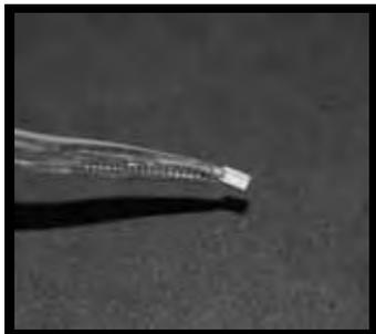
6. Secção de esmalte medindo aproximadamente 100  $\mu\text{m}$  de espessura que foi montado em lâmina microscópica para análise.
