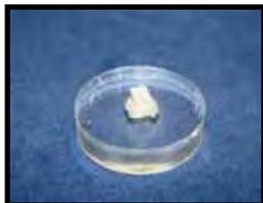
1. Bloco de esmalte fixado em disco de resina acrílica pré-fabricada ( $\pm 3$  cm de diâmetro por  $\pm 8$  mm de espessura), com auxílio de cera pegajosa (Kota Ind. e Com. LTDA), com a superfície dentinária voltada para cima.
