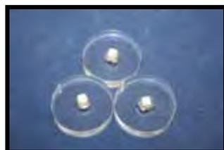
3. Blocos fixados com a superfície do esmalte voltada para cima, a qual será polida.
