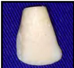
1. Coroa do dente bovino incisivo central inferior, separada da raiz através de disco diamantado de duas faces (KG Sorensen D 91), montado em motor de bancada (Nevoni), mantido sob refrigeração (água destilada/deionizada).
