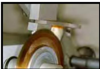
2. Secção da coroa utilizando disco diamantado (série 15 HC Diamond - n. 11-4244 Buehler) separando a superfície vestibular da lingual.
