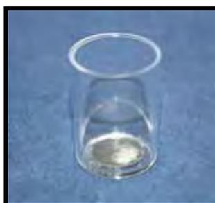
3. Após desgaste, pó de esmalte presente na lixa adaptada em frascos de poliestireno cristal (J - 7, Injeplast).
