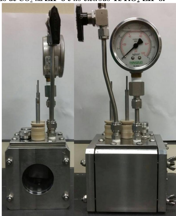
Figura 85 - Reator para adsorção de CO 2 na ZIF-8 e no eletrodo Ti/TiO 2 -ZIF-8 .
