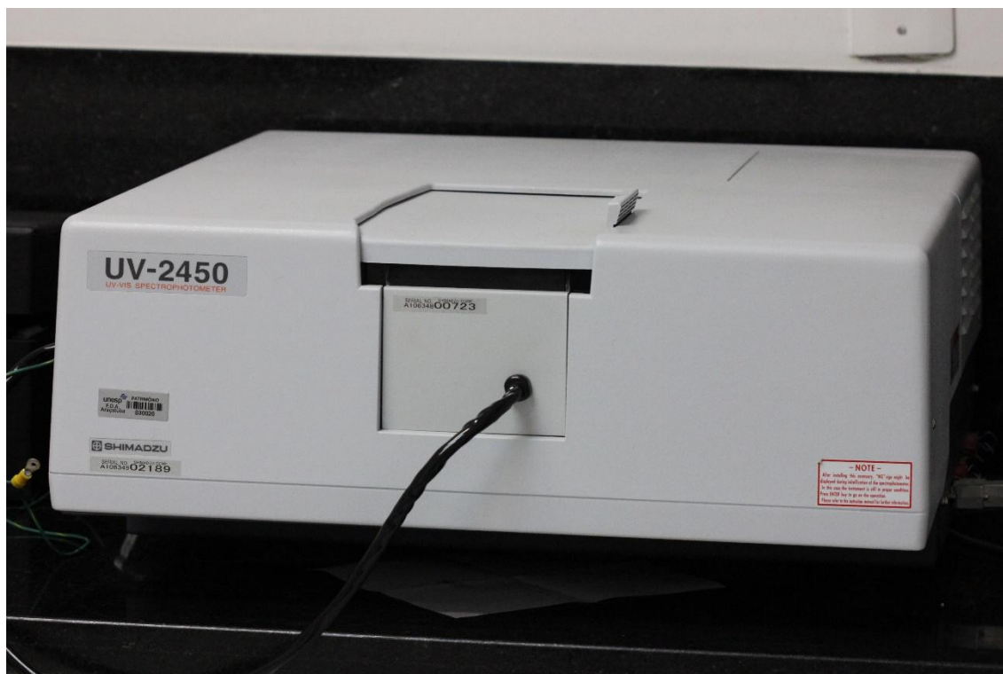
Figura 7 - Espectrofotômetro de Reflexão Ultravioleta Visível*, Modelo UV-2450 (Shimadzu, Kyoto, Japão)
