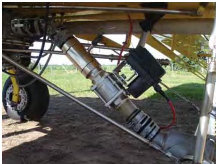
Figura 10. Controlador automático de vazão.
