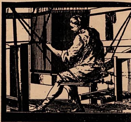
FIGURA 70 - Tear para tecidos trabalhados, criados por Jacquard. Fonte - ARP, 1988. p.24.
