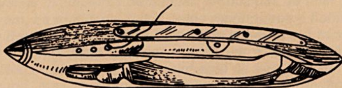
FIGURA 68 - Lançadeira - peça dos teares manuais Fonte - ARP, 1988. p.24.
