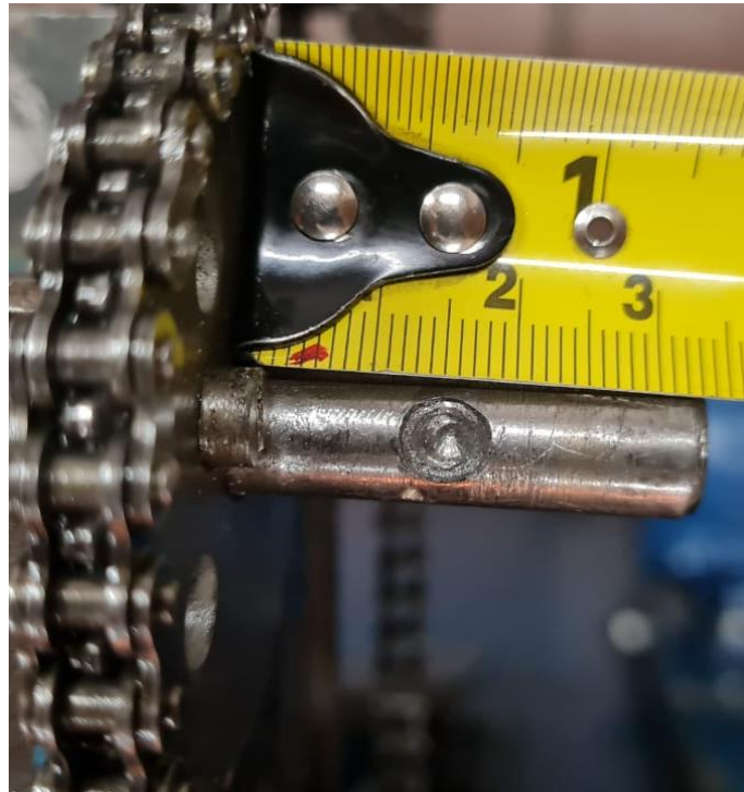
Figura 24 – Detalhe do canal aberto na ponta do eixo da esteira de roletes.
