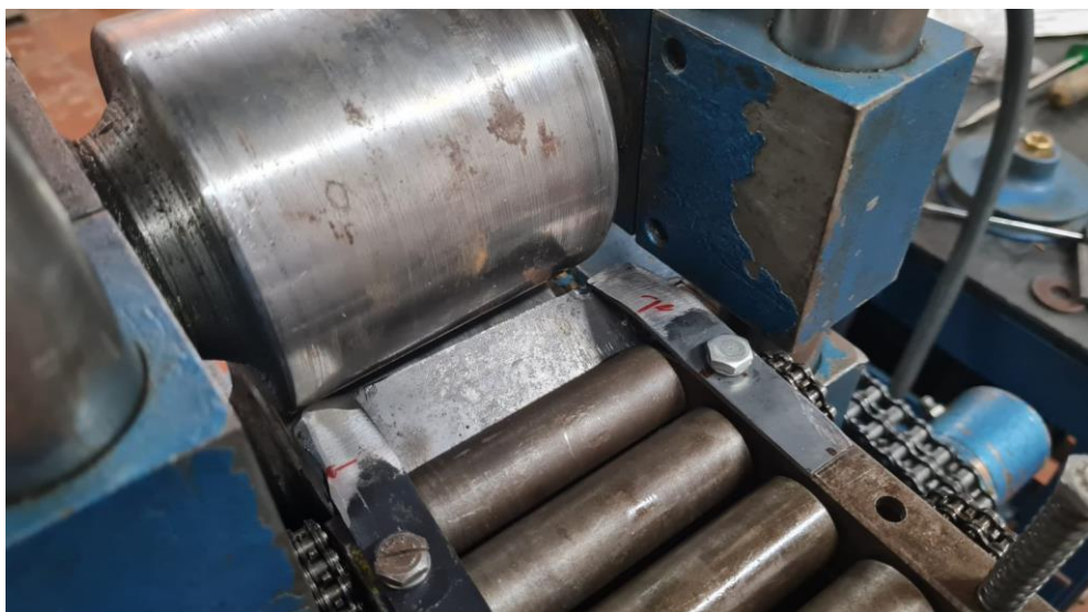
Figura 16 – (a) Detalhe da instalação do funil direcionador na esteira de roletes; (b) Vista traseira do funil instalado.
