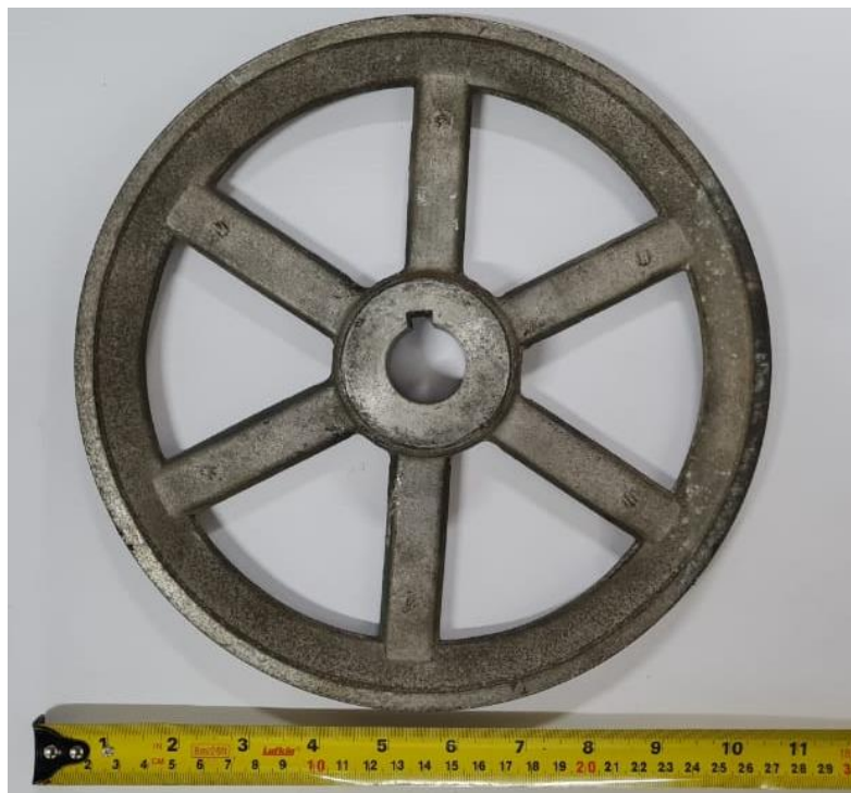
Figura 17 – Polia de 250 mm utilizada no sistema de transmissão.
