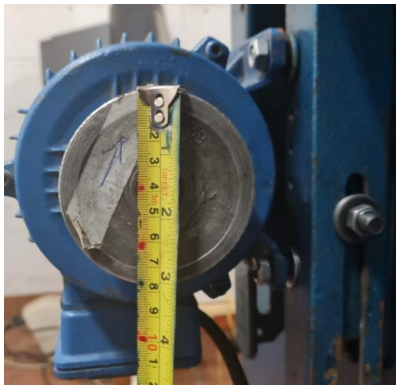
Figura 27 – Polia de 80 mm, acoplada no eixo do motor elétrico trifásico.
