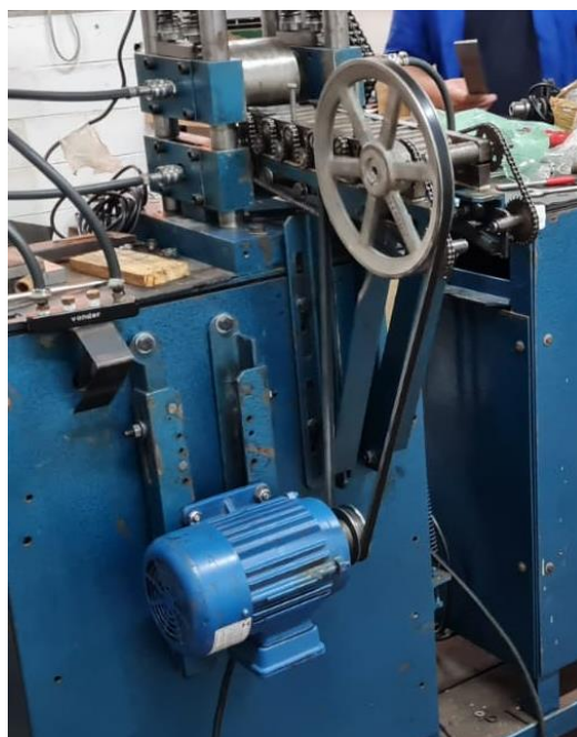
Figura 28 – Sistema de transmissão montado com a correia.
