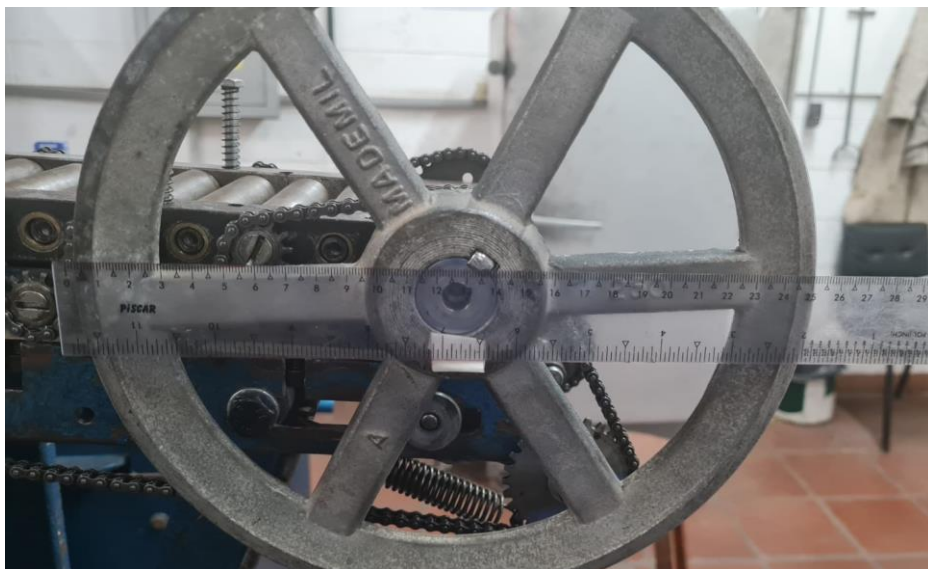
Figura 25 – Sistema acoplado no eixo da esteira dupla de roletes.
