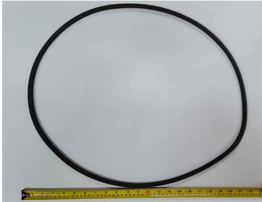
Figura 18 – Correia Continental A059 utilizada no sistema de transmissão.
