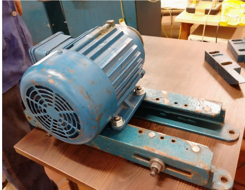
Figura 13 – Base desenvolvida para a fixação do motor elétrico trifásico de 1 cv no fundidor de tiras.
