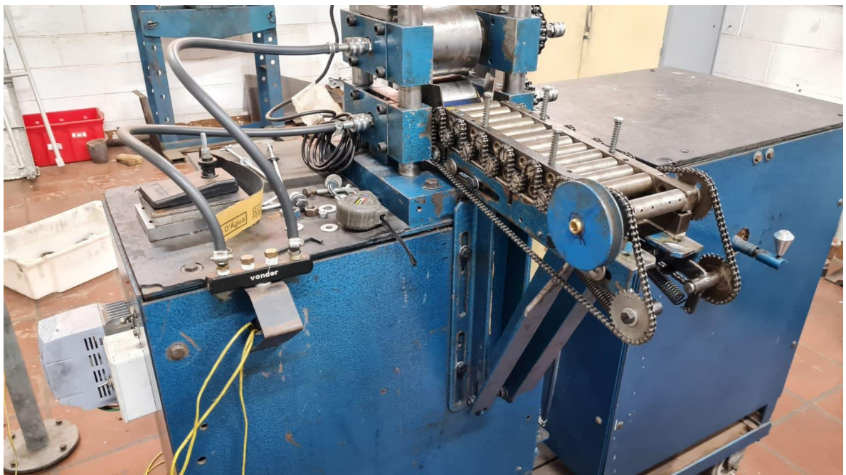
Figura 12 – Fundidor de tiras antes das modificações aplicadas.
