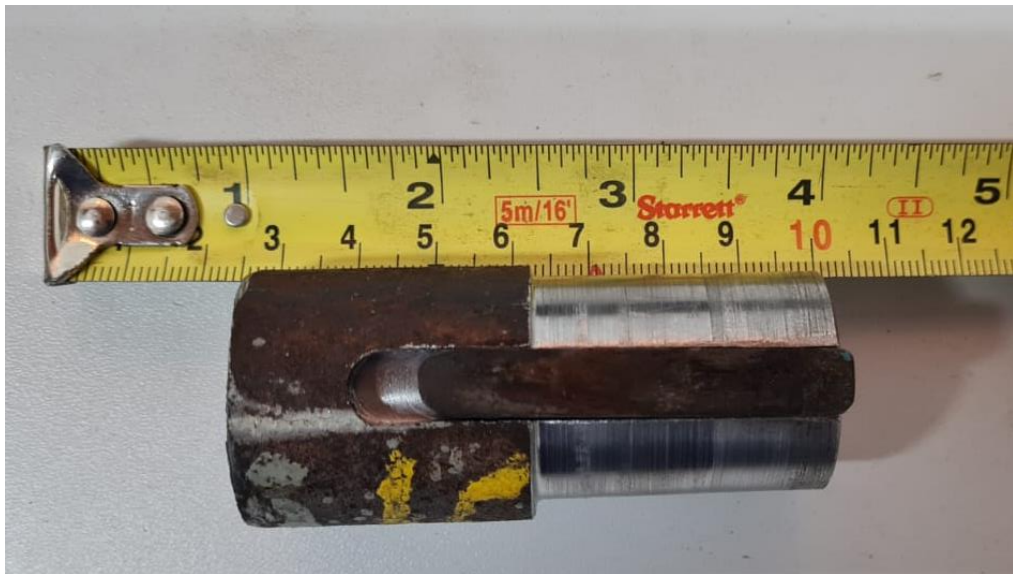
Figura 19 – Bucha com parte do tarugo não-usinado, antes do processo de corte.
