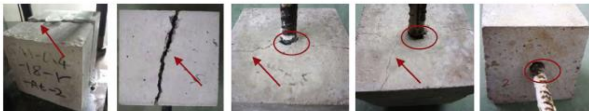
Figura 6 – Padrões de falhas na interface concreto/aço.
