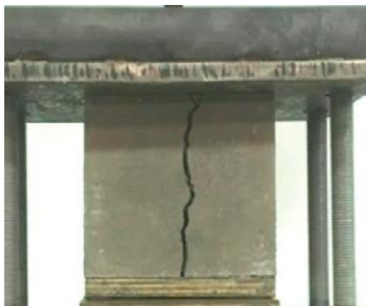
Figura 7 – Falha típica de escorregamento – colapso do concreto.
