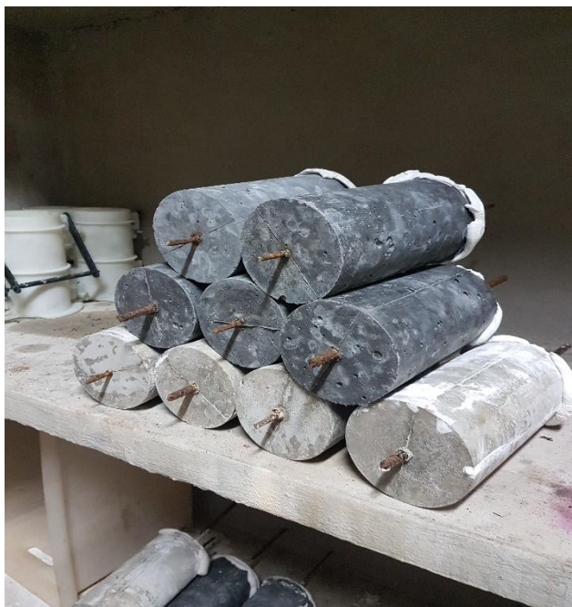
Figura 51 – Modo de ruptura do ensaio - CP's pós arrancamento.
