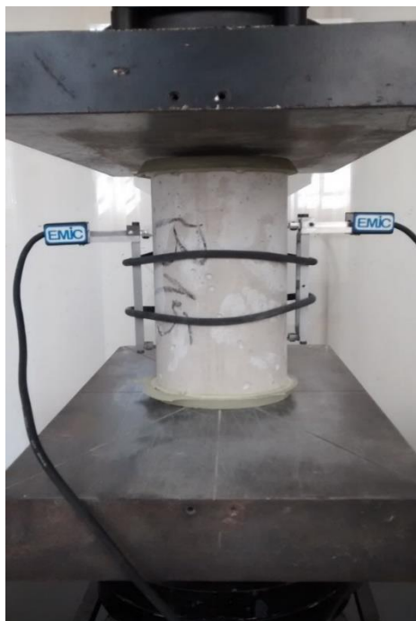
Figura 31 – Corpo de prova instrumentado para medição do módulo de elasticidade.
