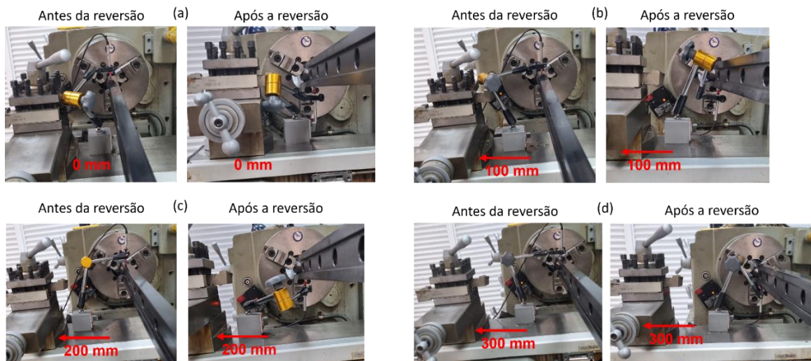
Figura 26 – Configurações experimentais com a barra orientada para medições do erro vertical nas posições transversais de (a) 0 mm; (b) 100 mm; (c) 200 mm e (d) 300 mm.
