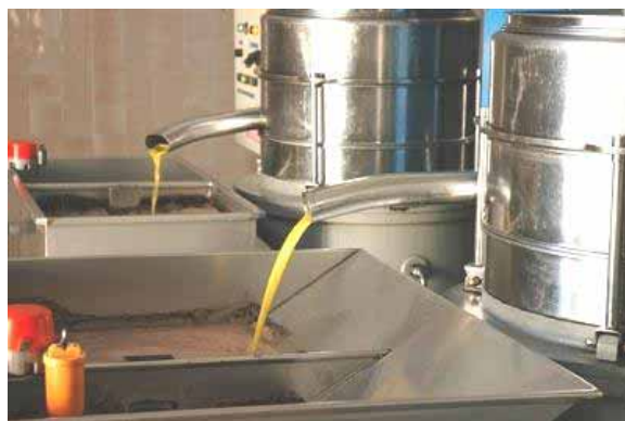
Figura 3: Extração por pressão mecânica.
