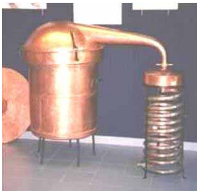
Figura 7: Extração com vapor ou coobação.
