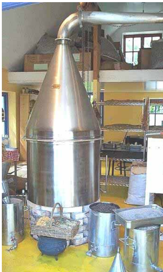
Figura 6: Extração por arraste com vapor d'água.
