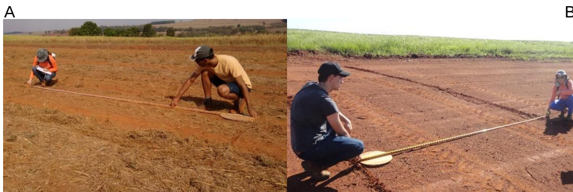
Figura 12. Medição do paralelismo entre dois semicírculos (A e B).
