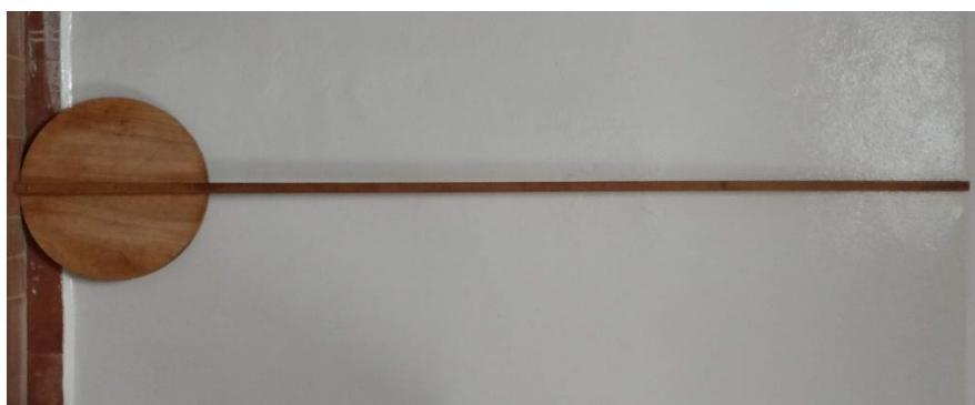
Figura 7. Instrumento “pirulito” usado para auxiliar na medição do paralelismo.
