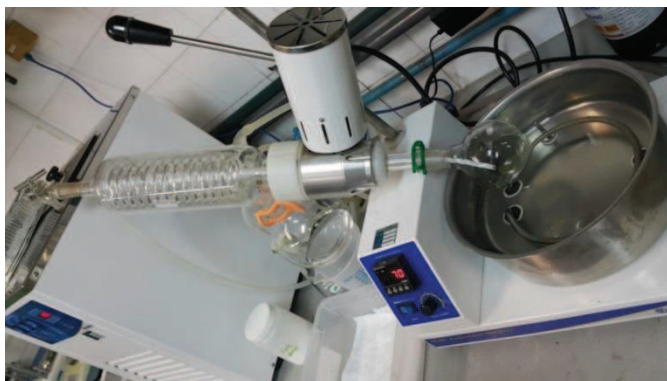
Figura 8 - Evaporador rotativo com banho termostático e sistema de vácuo.
