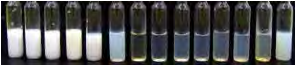
Figura 17. Amostras com valores de EHL entre 15,4 e 9,1 respectivamente imediatamente após a preparação dos sistemas microemulsionados.
