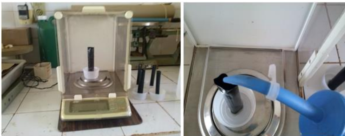
Figura 14. Método de determinação do diâmetro interno da mangueira gotejadora através do volume.
