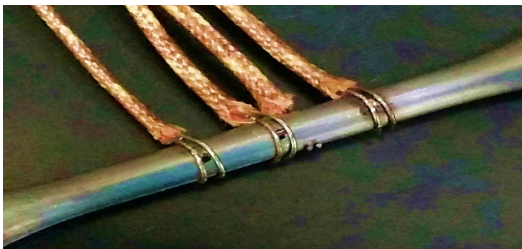
Figura 9: Termopares soldados à superfície do corpo de prova.
