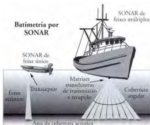
Figura 23 – Esquema de aquisição de dados ecobatimétricos (JENSEN, 2009)
