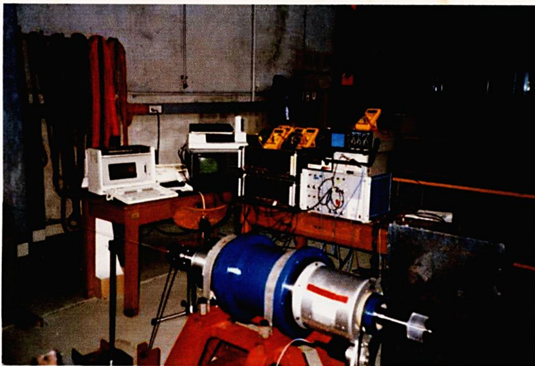
Foto 3 – Dispositivo de medida durante a calibração estática
