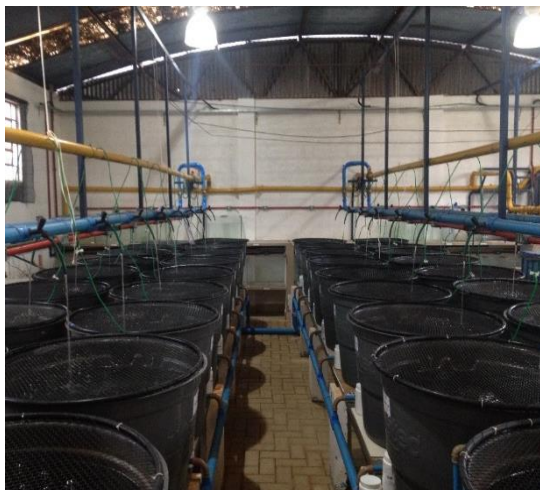
Figura 2. Sistema de recirculação composto por 36 unidades experimentais no total.
