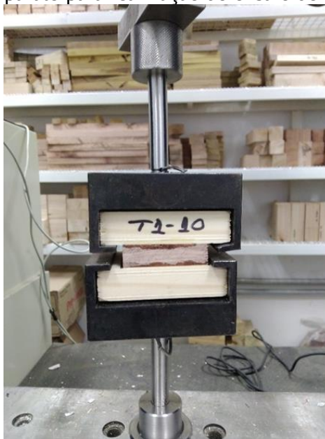
Figura 16 - Aparato para realização do ensaio de adesão interna
