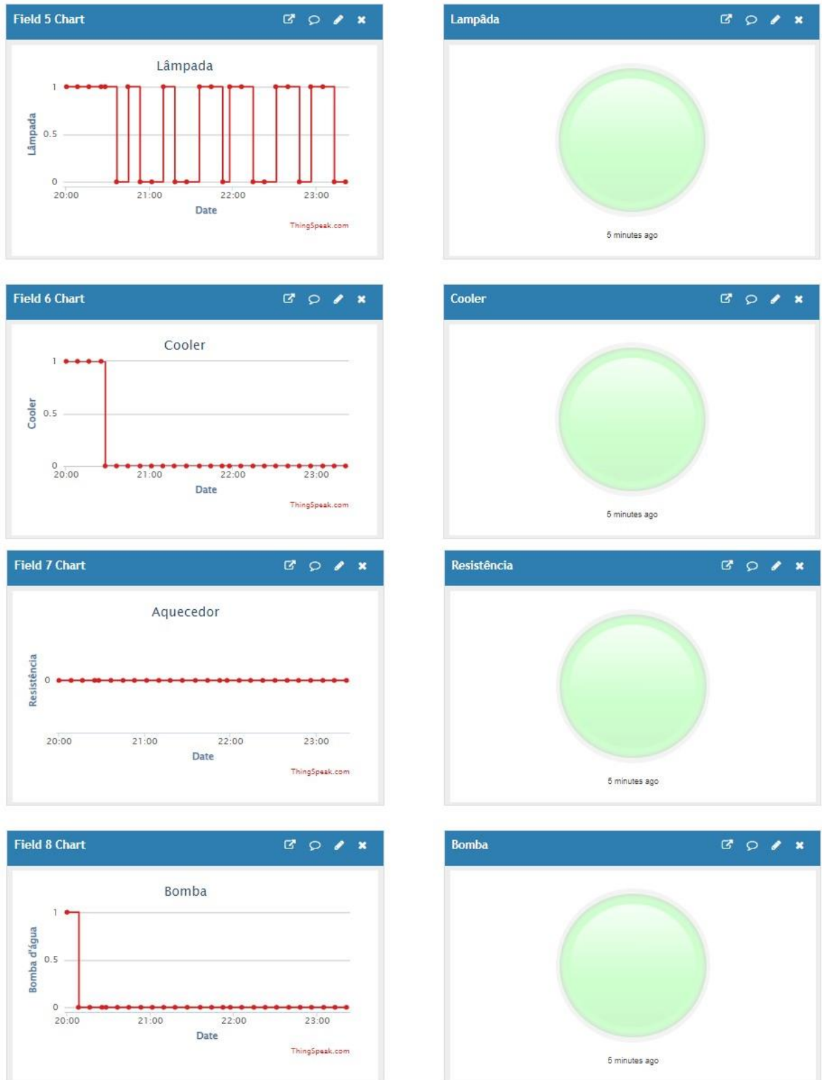
Figura 37 - Visualização do estado de duas das saídas ao longo do tempo e de seus respectivos indicadores luminosos na plataforma
