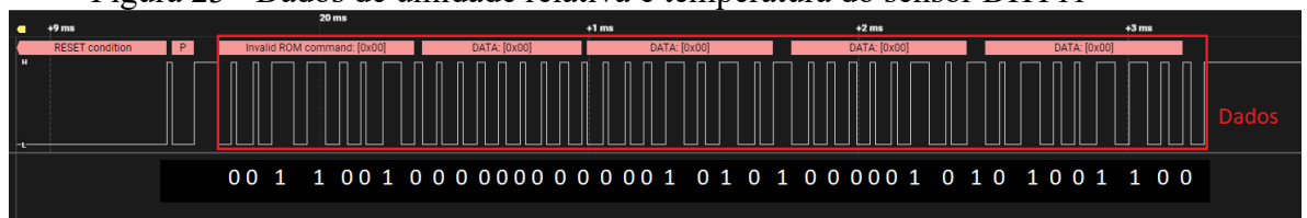
Figura 23 - Dados de umidade relativa e temperatura do sensor DHT11
