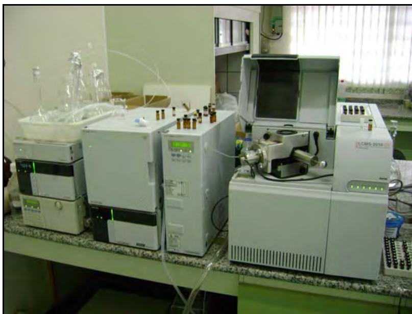
Figura 8. Cromatógrafo Líquido de Alta Eficiência (CLAE) e espectrômetro de massas utilizado no desenvolvimento do método analítico de determinação do amicarbazone.
