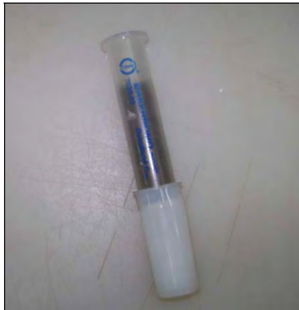
Figura 5. Detalhe do cartucho utilizado na extração de solução do solo, com o compartimento de coleta da solução acoplado.
