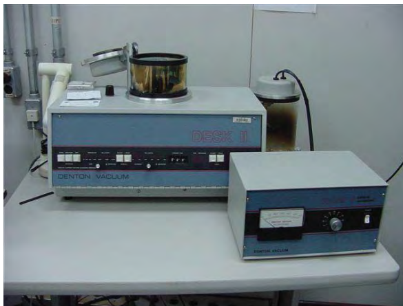
Figura 4 - Evaporador de alta pressão (DV-502-Dentron NJ) onde os cones foram metalizados com ouro para tornarem-se materiais condutores e viabilizar o teste de EDS.
