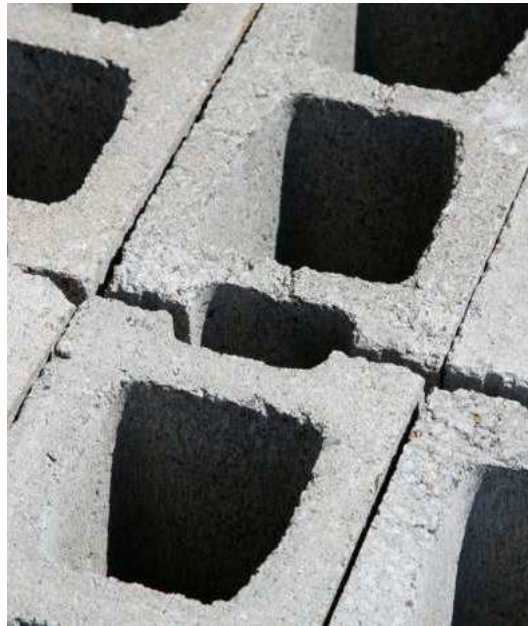
BLOCO DE CONCRETO
