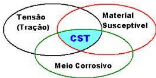
Figura 3 - Corrosão sob tensão
