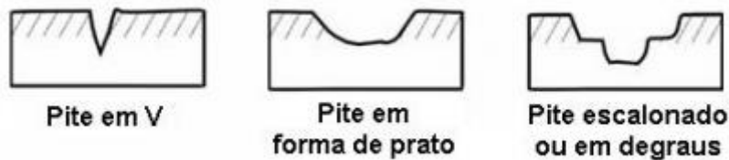
Figura 7 – Alguns exemplos de morfologia dos pites de corrosão
