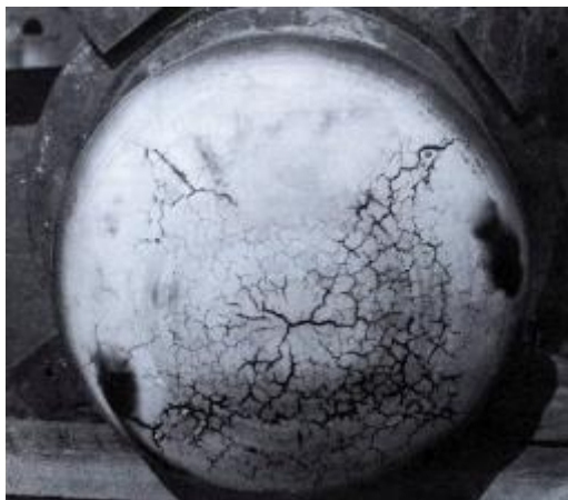
Figura 4 - Corrosão sob tensão em um autoclave de aço 304
