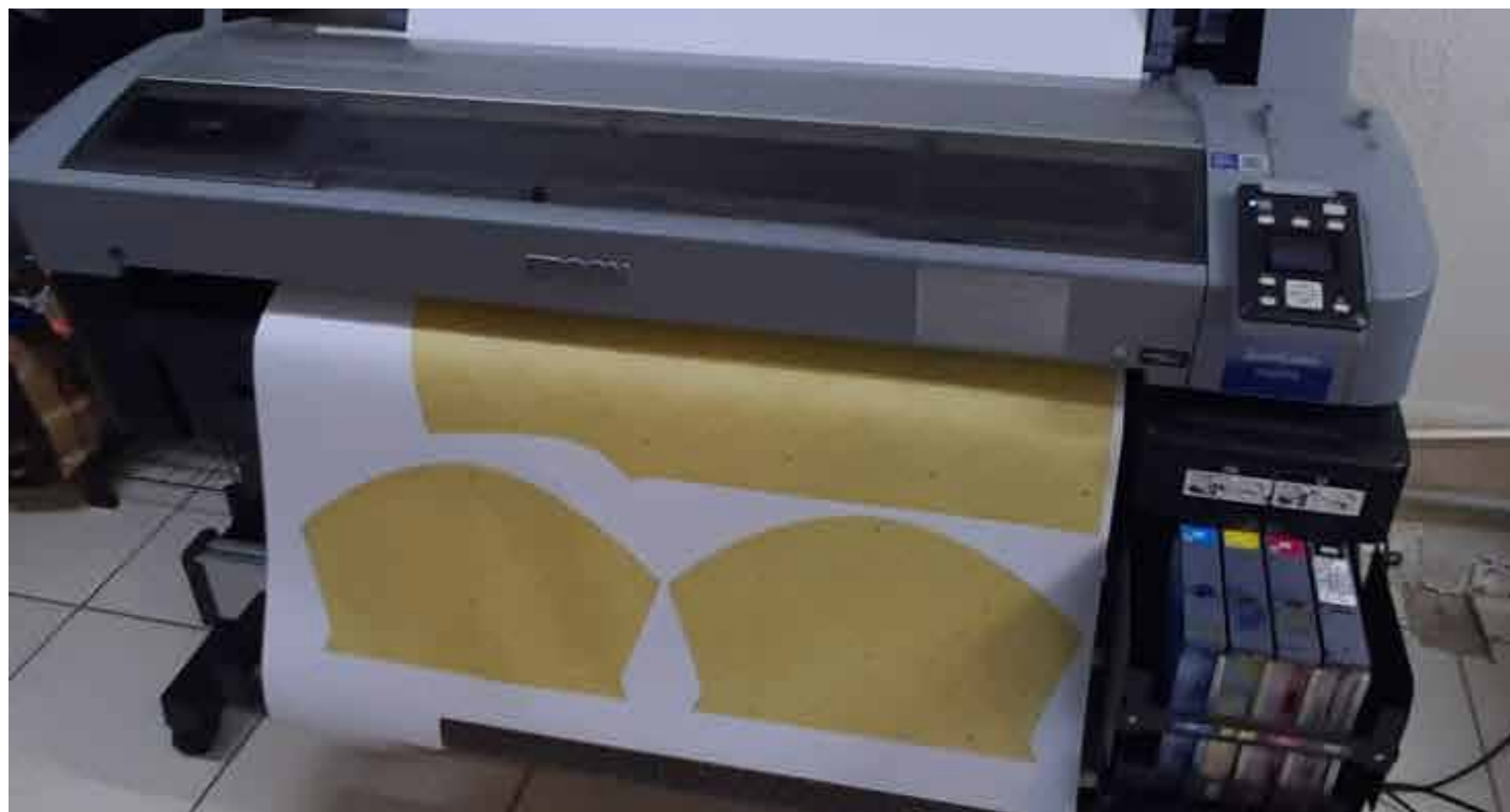
Processo de Impressão Sublimática em Impressora Epson Acervo pessoal
