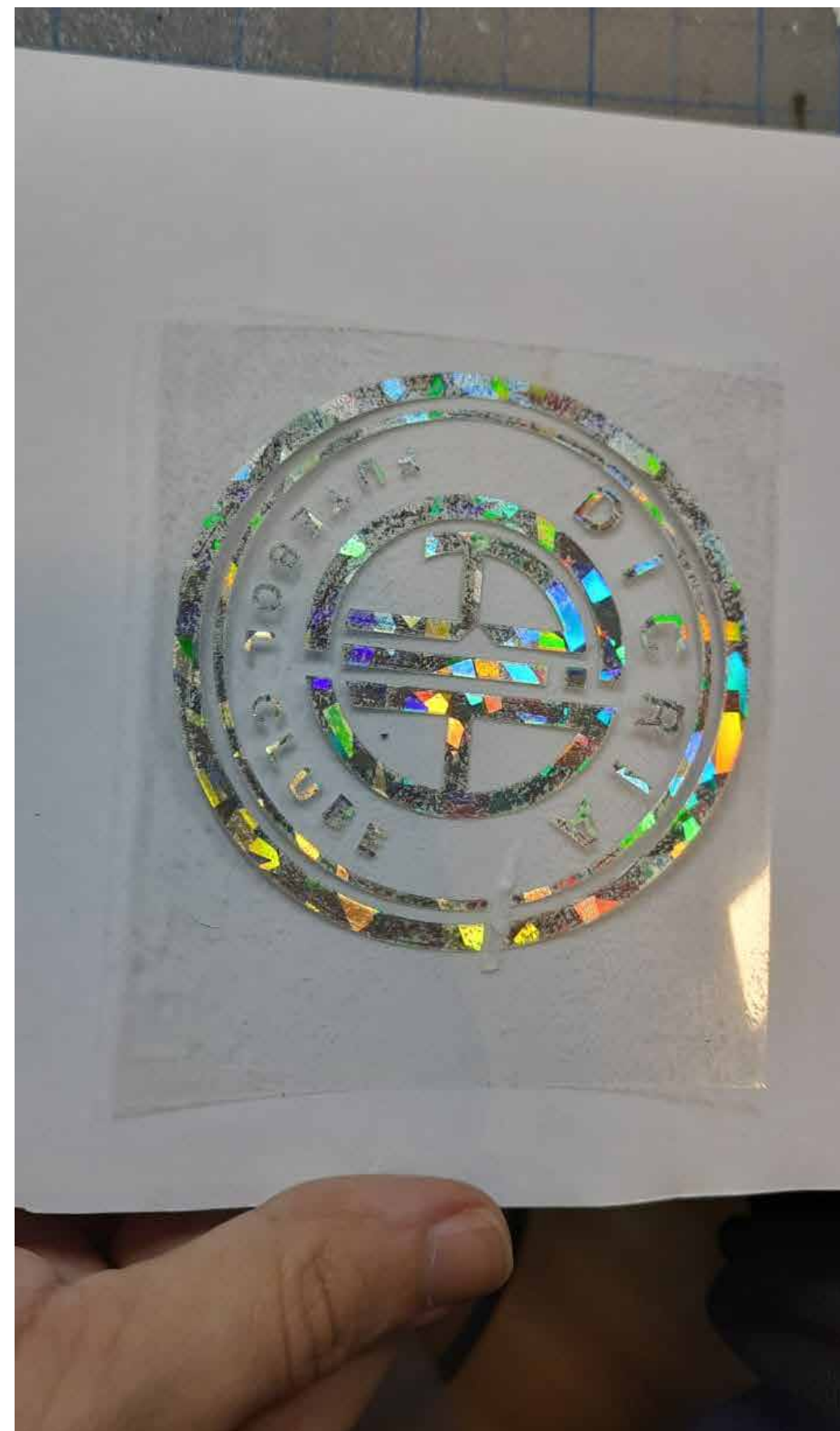
Processo de “depilação” do vinil após o corte Acervo pessoal
