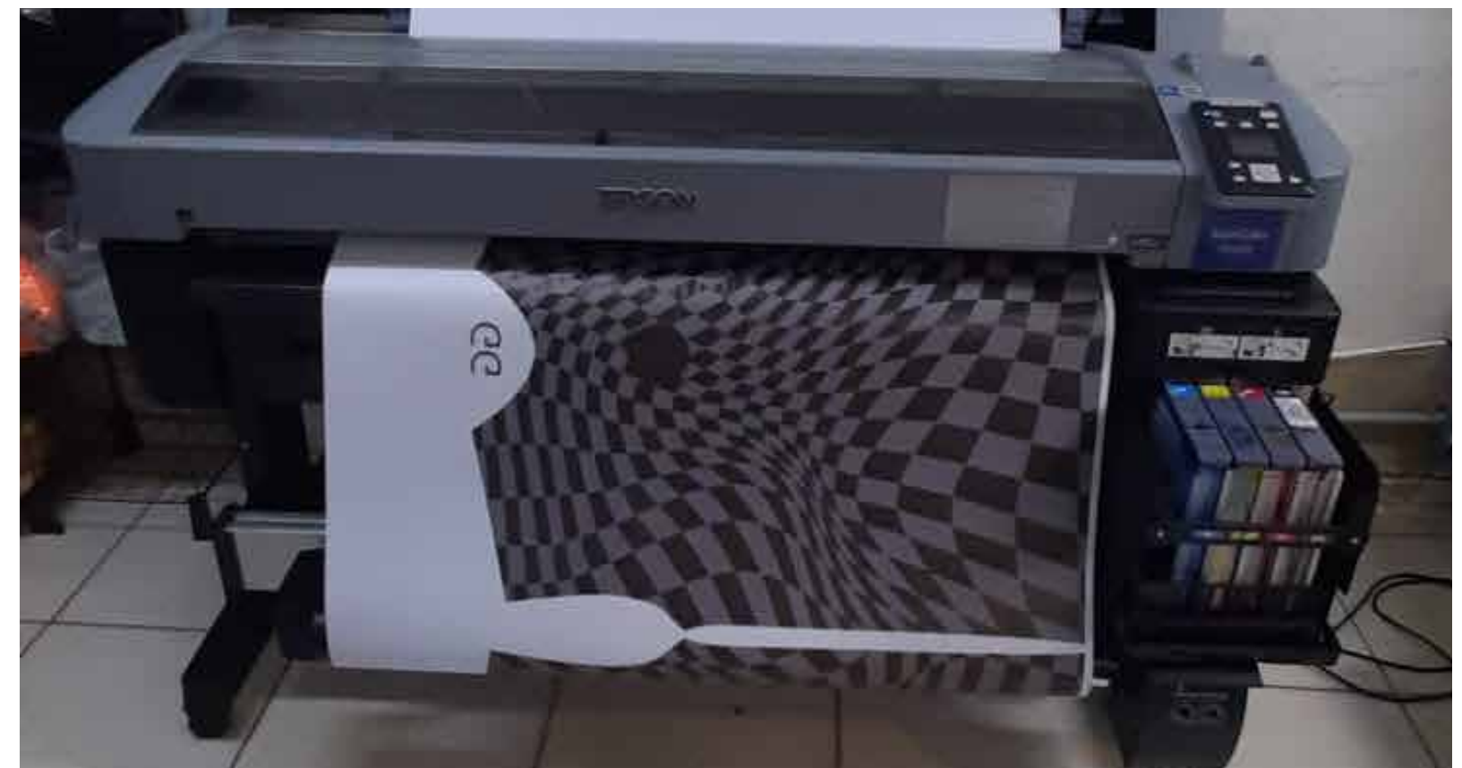
Processo de Impressão Sublimática em Impressora Epson Acervo pessoal
