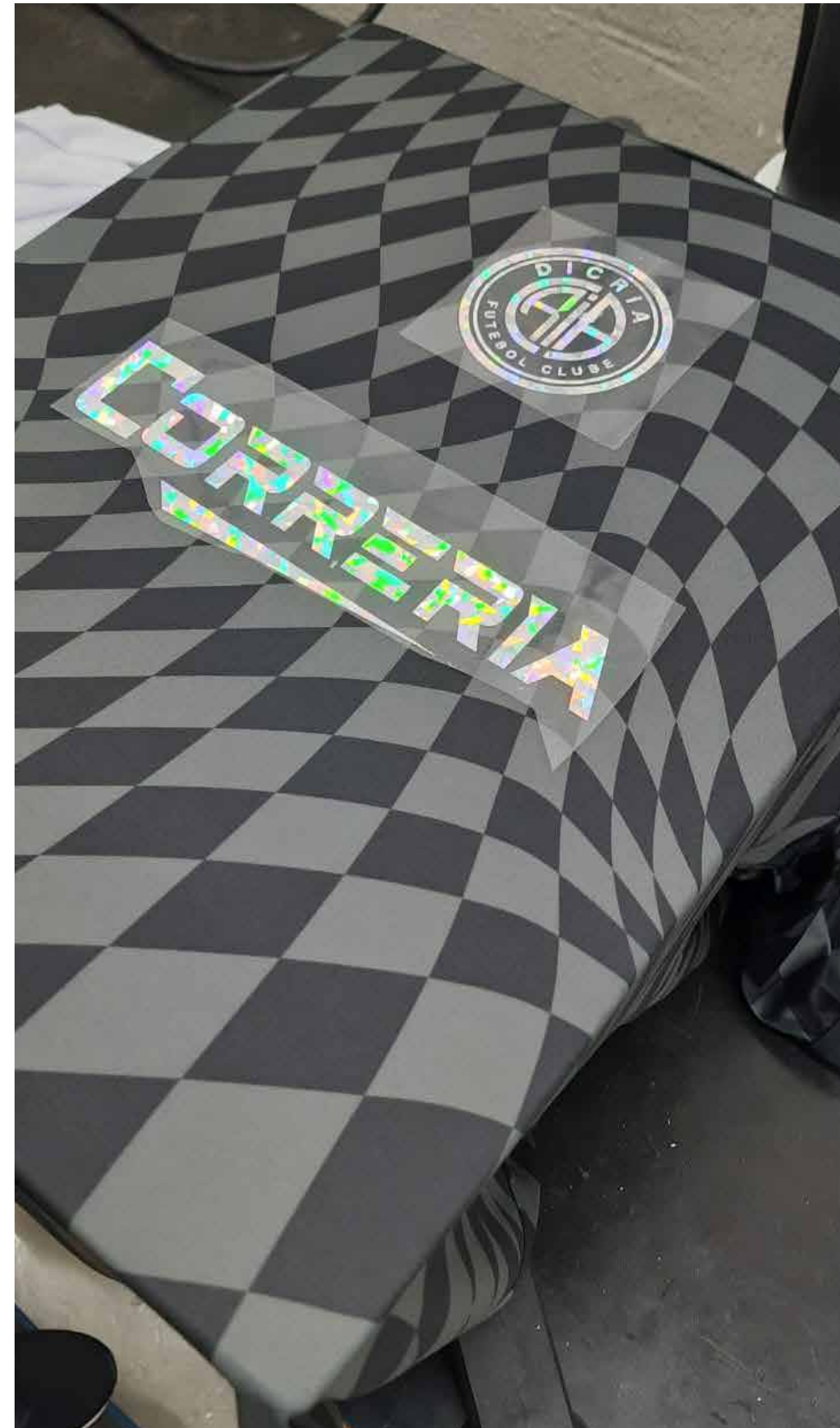
Aplicação de DTF e Vinil térmico holográfico nas peças Acervo pessoal
