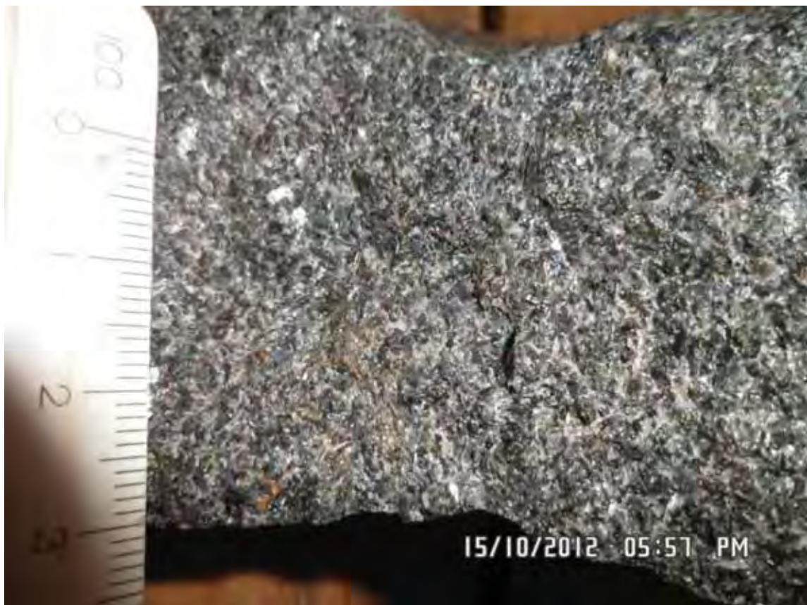
Figura 7.32: Detalhe de gabronorito exibindo textura cumulática a granoblástica, composto essencialmente por cristais amarronzados e escuros de piroxênios e por plagioclásio esbranquiçado (ponto BV387).
