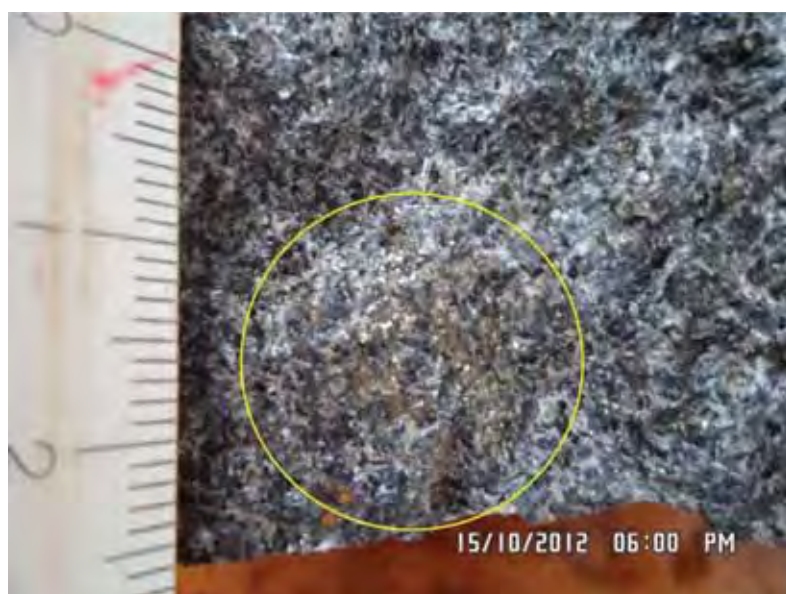
Figura 8.1: Detalhe de amostra de gabronorito (ponto BV387) exibindo sulfetação intercumulus (círculo amarelo) composta essencialmente por pirrotita.
