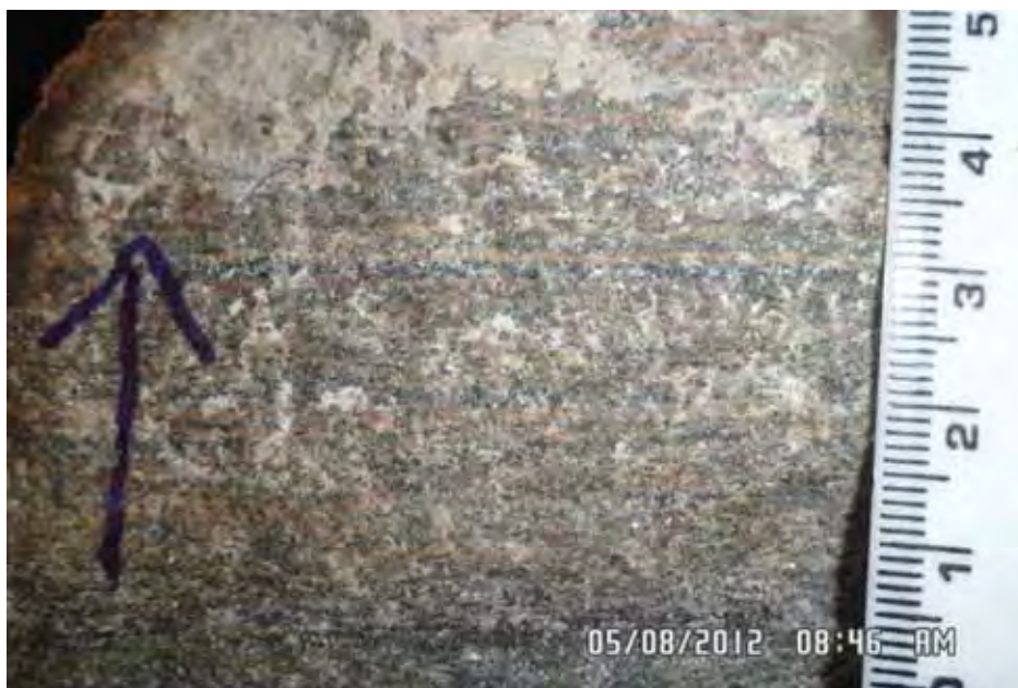
Figura 7.15: Detalhe de amostra de calciossilicática, exibindo bandas milimétricas ricas em granada, epidoto e clinopiroxênio (ponto BV069).
