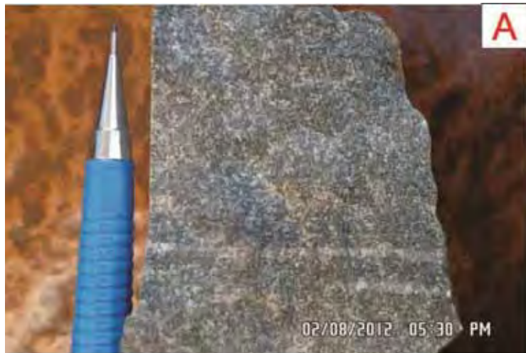
Figura 7.12: Amostras de rocha calciossilicática/ formação ferrífera com estrutura gnáissica incipiente (A) e nítida (B), dos pontos BV070 e BV032, respectivamente.
