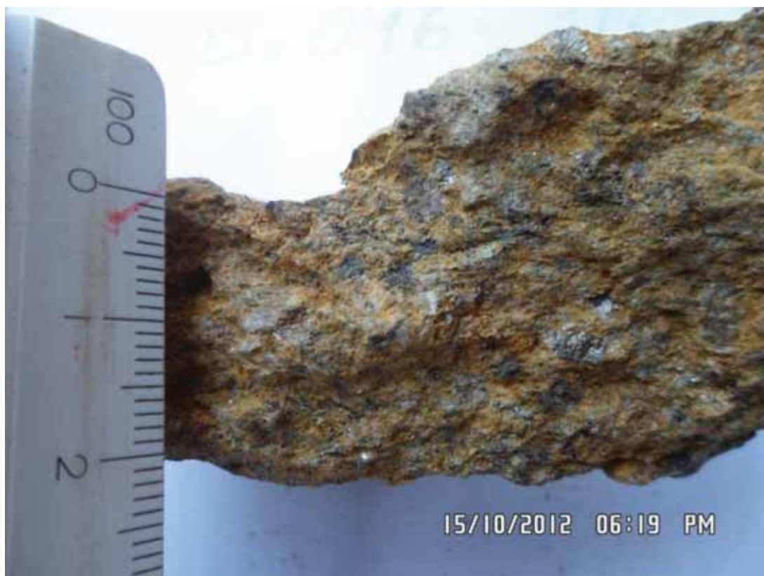
Figura: 7.9: Detalhe de metaperidotito anfibolitizado e alterado, com pseudomorfos de olivina de coloração escura (ponto BV046).
