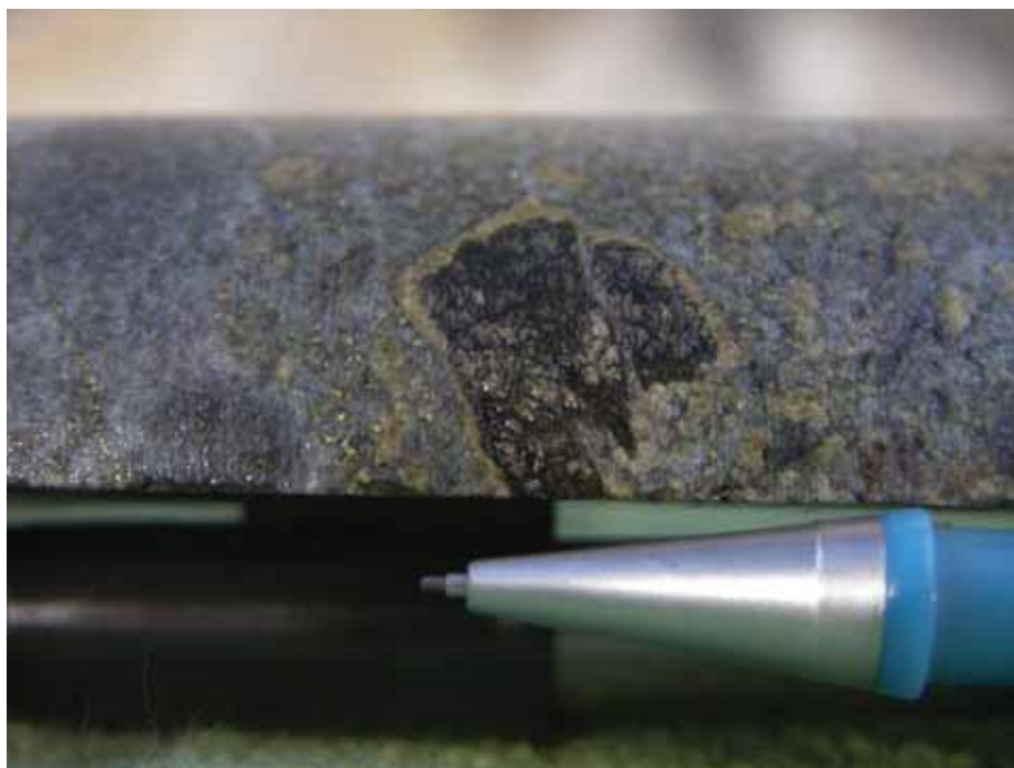
Figura 7.26: Detalhe de megacristal de olivina (preto) com inclusões de serpentina (esbranquiçado) e coroa de reação de ortopiroxênio (borda beje) em metagabronorito.
