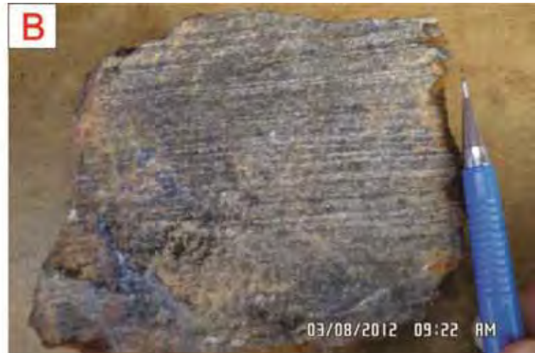
Figura 7.12: Amostras de rocha calciossilicática/ formação ferrífera com estrutura gnáissica incipiente (A) e nítida (B), dos pontos BV070 e BV032, respectivamente.
