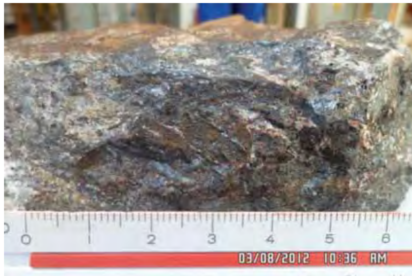
Figura 7.13: Detalhe de amostra de formação ferrífera fácies óxido, composta por hematita, magnetita e quartzo (ponto BV016).
