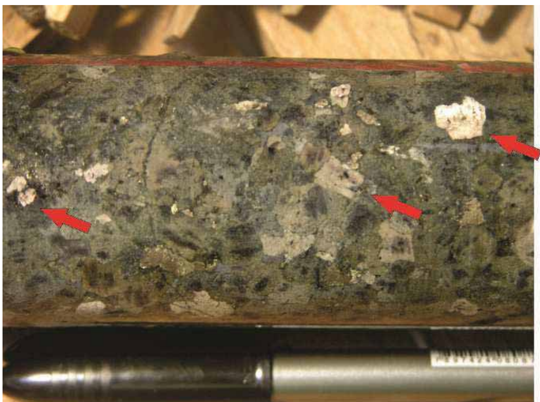
Figura 7.5: Detalhe de ortopiroxenito em testemunho de sondagem, exibindo textura cumulática, composto predominantemente por cristais de ortopiroxênio (seta vermelha).
