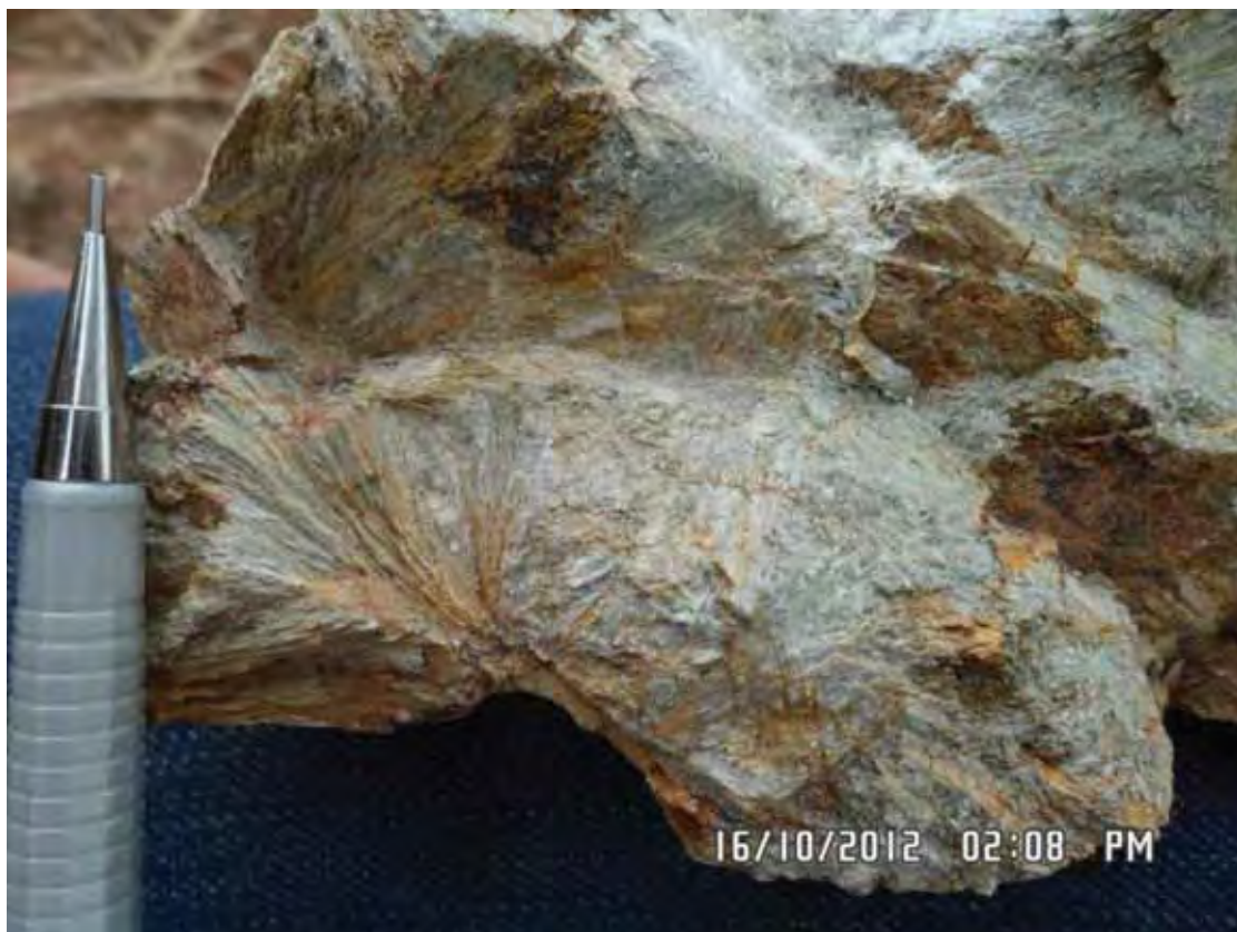
Figura 7.36: Detalhe de amostra de anfibólio fels, com cristais prismáticos e radiais de tremolita ou antofilita (ponto BV540).
