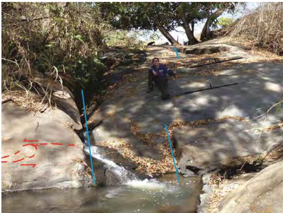
Figura 7.21: Ilustração de feições estruturais na borda sul do complexo de Mangabal Sul (ponto BV166), com detalhe para a atitude do plano de foliação (em preto), direção preferencial de fraturamento (em azul) e indicador cinemático em veio pegmatítico deformado (foto com visada para sudeste).
