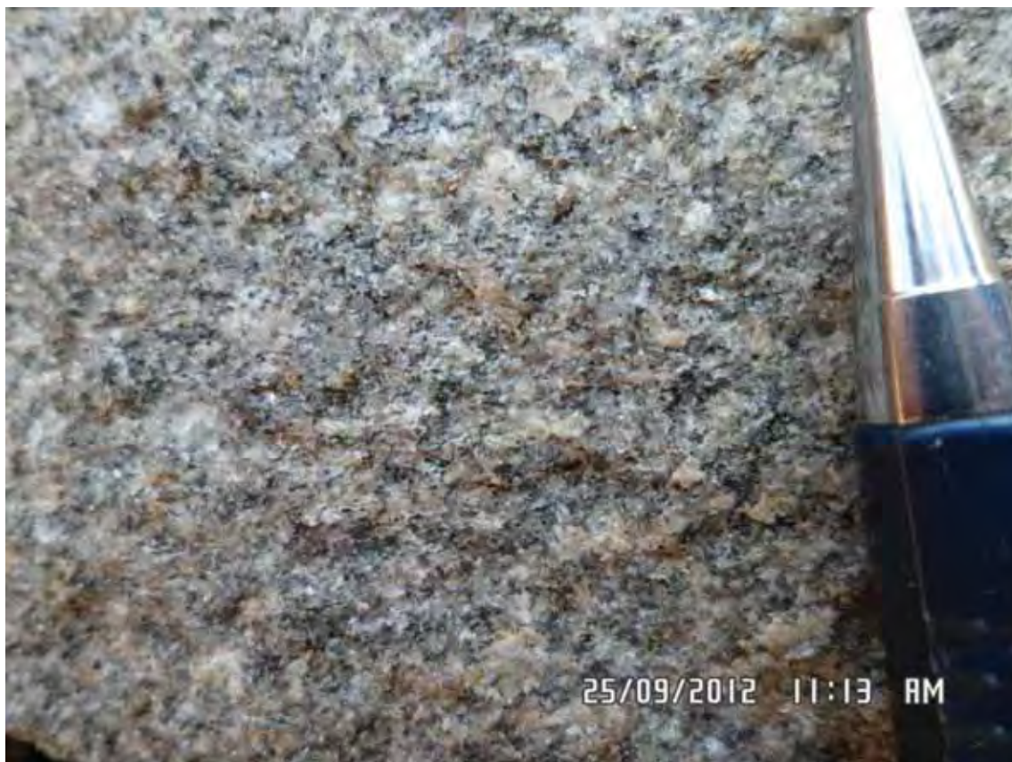
Figura 7.42: Detalhe de amostra de granodiorito de granulação fina, exibindo estrutura isótropa (ponto BV296).
