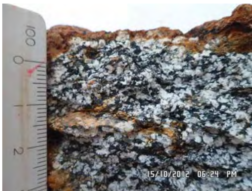
Figura 7.17: Detalhe de anfibolito exibindo estrutura levemente gnáissica, com cristais escuros de anfibólio + opacos e esbranquiçados de plagioclásio (ponto BV062).
