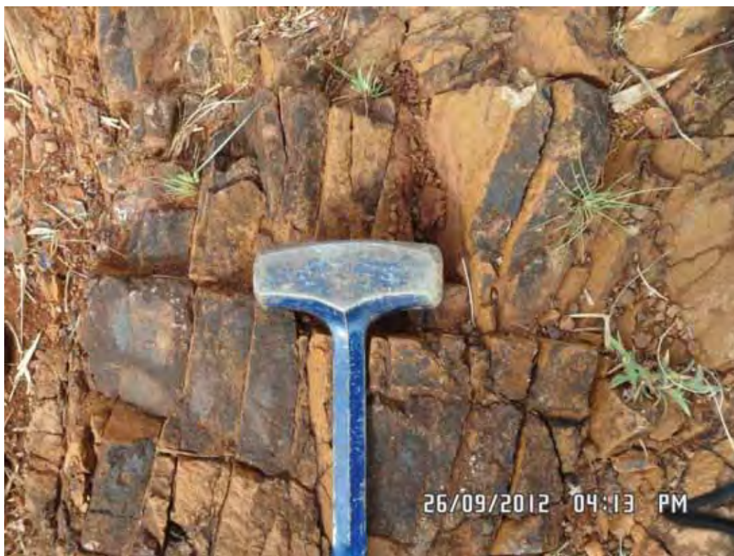
Figura 7.47: Detalhe de metaultramáfica (tremolitito) do ponto BV362 exibindo foliação espaçada disjuntiva ou de crenulação.
