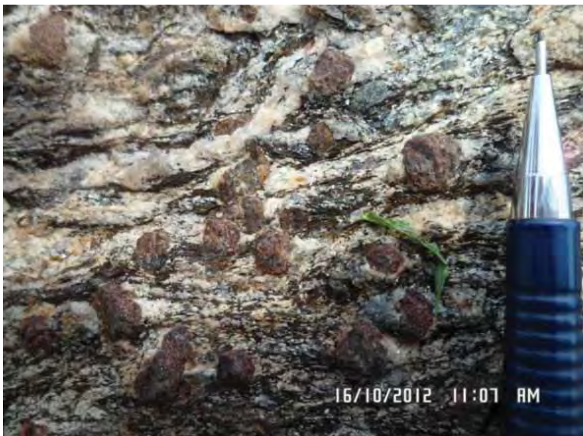
Figura 7.39: Detalhe de amostra de granada-biotita gnaiss com anfibólio exibindo porfiroblastos de granada (ponto BV528).
