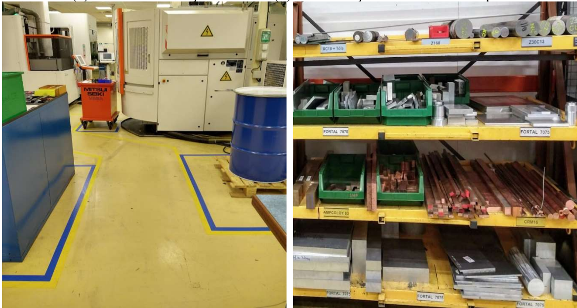
Figura 8 - Implementação da Gestão Visual (a) Novas delimitações do solo (b) Identificações visuais do estoque.
