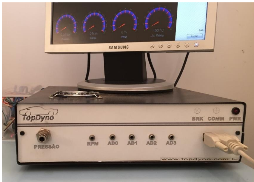
Figura 24 - Central de controle e aquisição de dados do freio eletromagnético.
