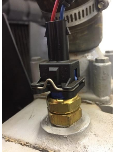
Figura 41 - Sensor de temperatura do motor conectado ao sistema de injeção.
