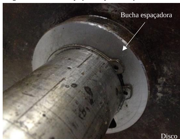
Figura 17 - Bucha espaçadora para fixação dos discos.
