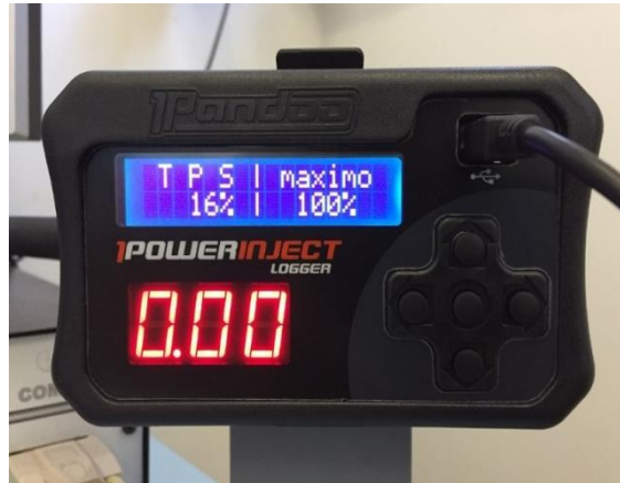
Figura 34 - Central eletrônica Power Inject da Pandoo.
