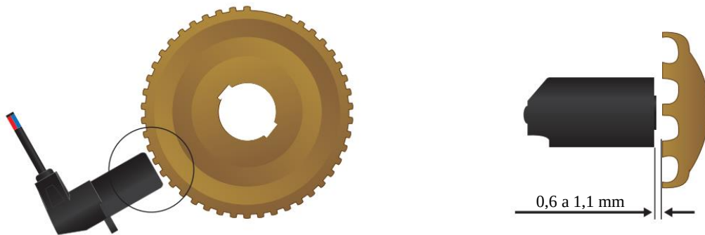
Figura 35 - Distância adequada entre sensor de rotação e polia fônica.
