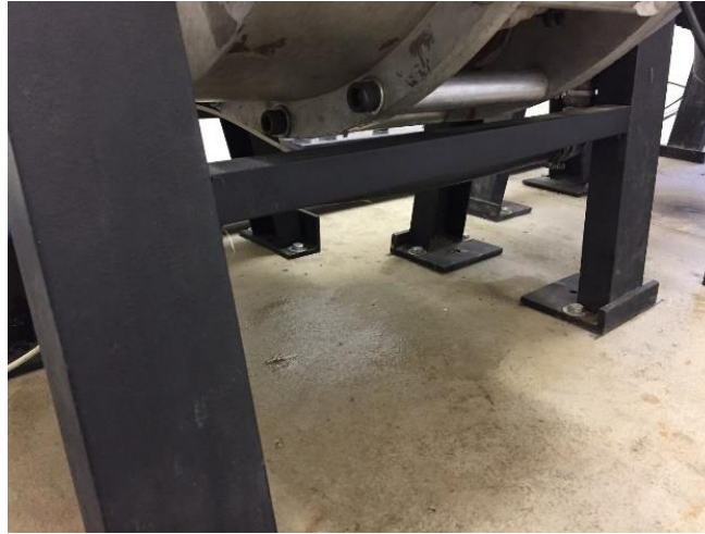
Figura 9 - Braço de travamento dos suportes do freio.
