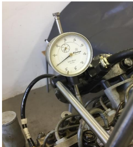
Figura 37 - Posicionamento do relógio comparador no cabeçote do motor.
