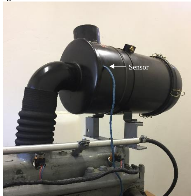
Figura 28 - Termistor instalado no coletor de admissão.
