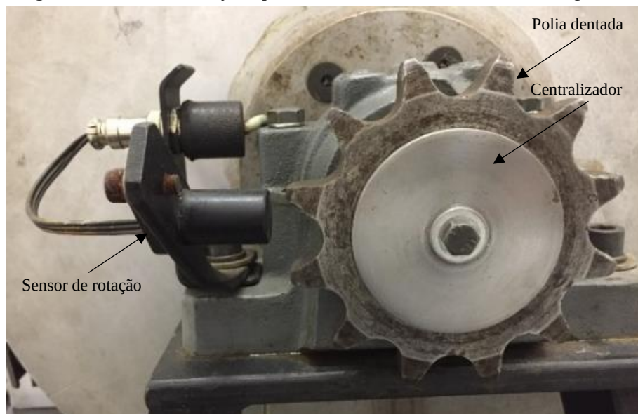
Figura 18 - Sensor de rotação e polia instalados no eixo do freio eletromagnético.
