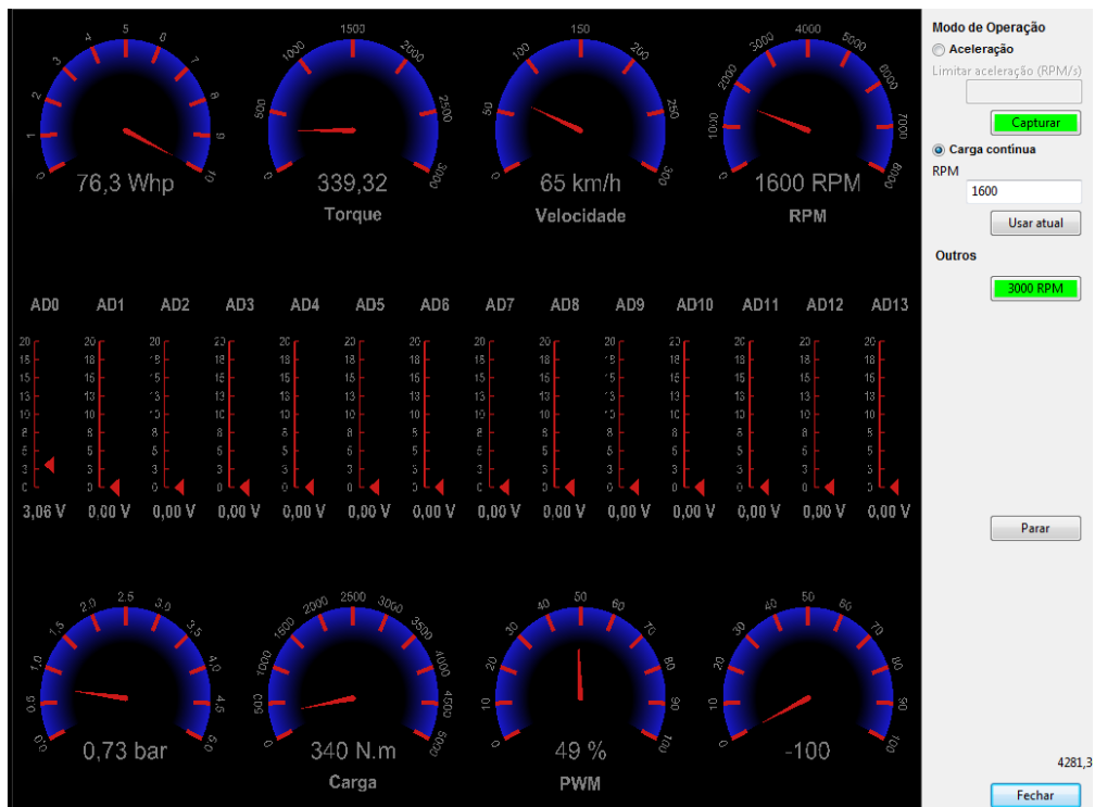
Figura 50 - Interface gráfica de controle do dinamômetro.
