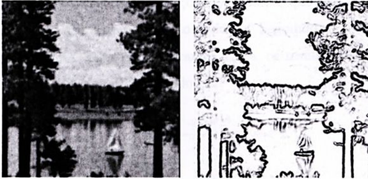
Figura 4.24 (a) e (b): Imagem recuperada pelo modelo YK - c(|\nabla^2 u|) , utilizando o coeficiente de difusão (4.2) e respectiva segmentação.
