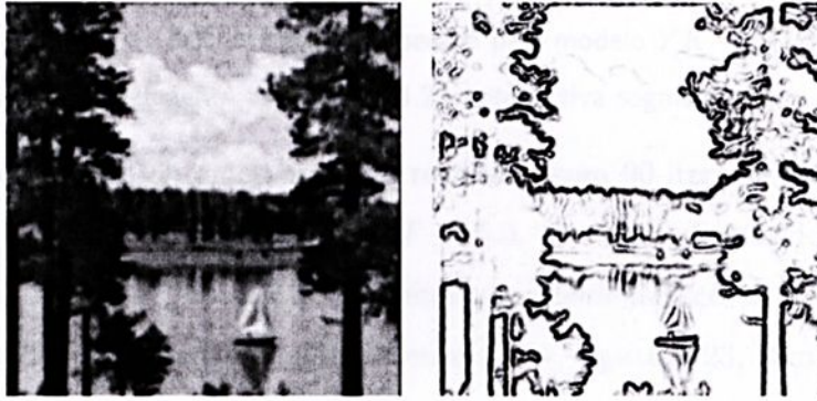
Figura 4.23 (a) e (b): Imagem recuperada pelo modelo YK - c(|\nabla u|) , utilizando o coeficiente de difusão (4.2) e respectiva segmentação.
