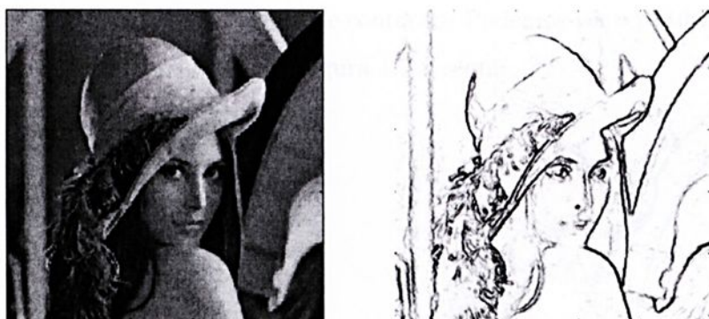
Figura 1.6 (a) e (b): Imagem processada com 25 iterações utilizando o coeficiente de difusão (1.96) e respectiva segmentação.
