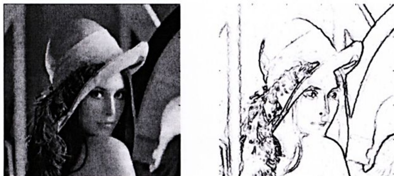
Figura 1.8 (a) e (b): Imagem processada com 270 iterações utilizando o coeficiente de difusão (1.102) e respectiva segmentação.
