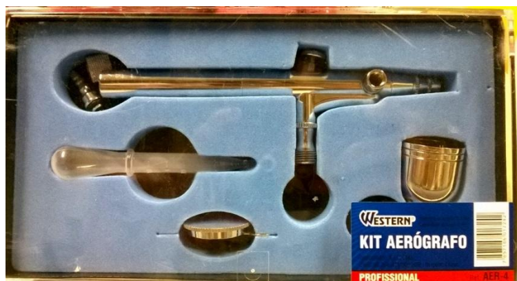
Figura 3.1– Kit aerógrafo utilizado para aplicação da técnica de “ Spray-Coating ”
