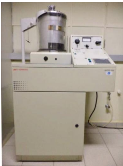
Figura 3.5 – Evaporadora de metais. Modelo Auto 306 Coater, fabricante BOC EDWARDS.
