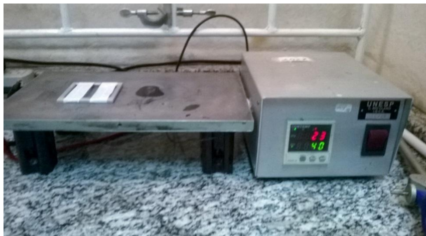
Figura 3.2– Arranjo para deposição dos filmes com chapa de metal para controle de temperatura.
