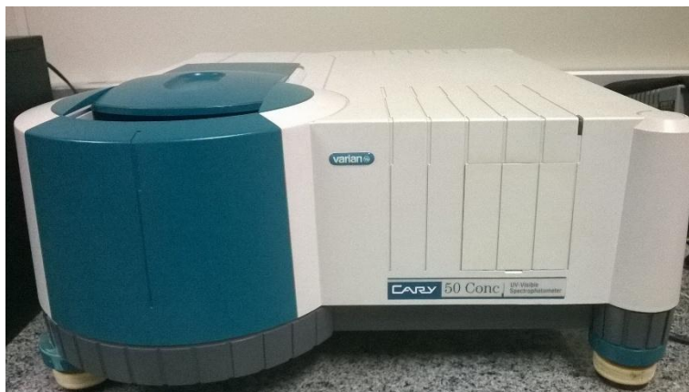
Figura 3.10 - Espectrofotômetro de absorção UV-Vis Varian Cary 50.
