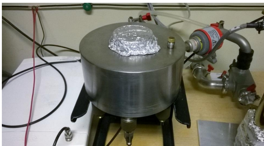
Figura 3.8 – Câmara de metal utilizada para isolamento da amostra.
