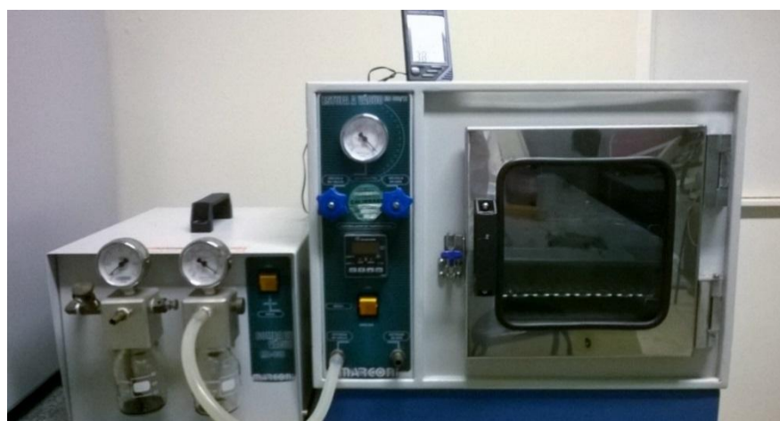
Figura 3.3 – Estufa com controle de vácuo utilizada para manter os filmes à 40°C.
