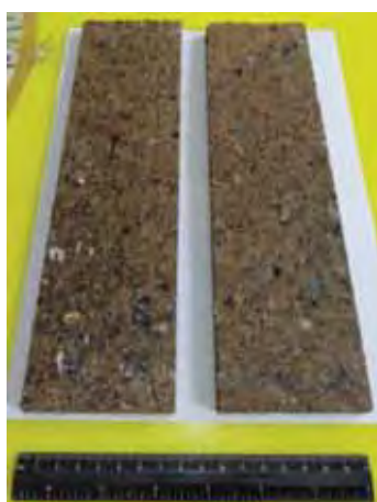
a) Corpos de prova para ensaio de flexão estática (MOR e MOE).
