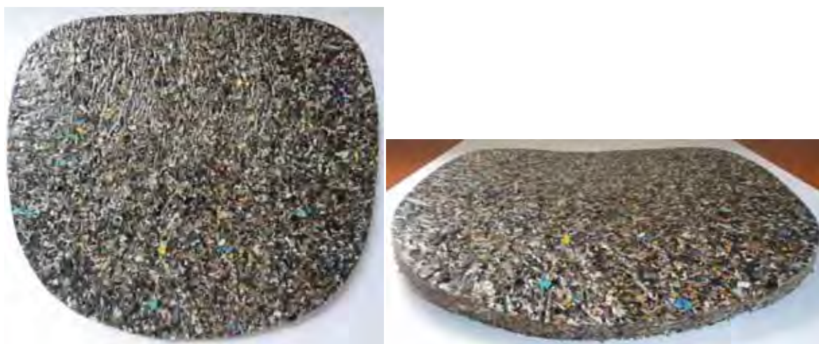
Figura 32 - Encosto de cadeira feito com painel 70% resíduos termoplásticos e 30% resíduos da pupunheira.
