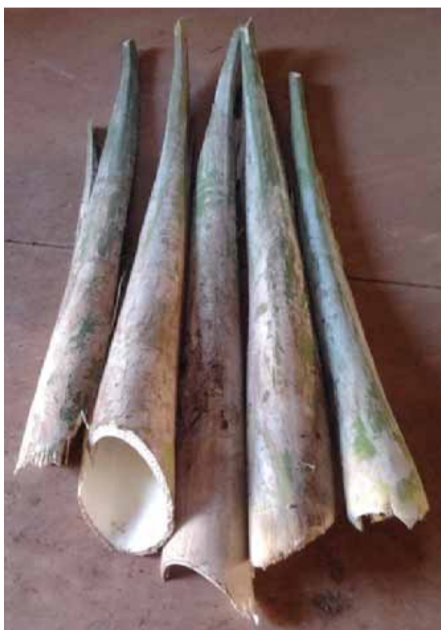
b) Bainha - camada externa (Teor de umidade = 81,12%)
