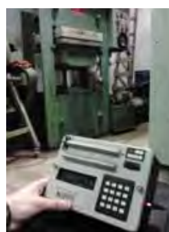
b) Datalogger e termopar no momento da prensagem do painel.
