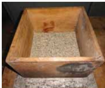
Figura 18 - Caixa formadora do painel.
