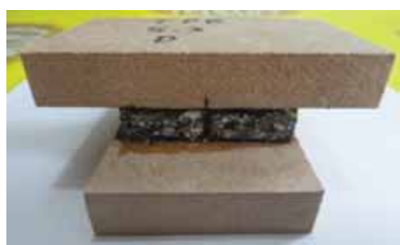
b) Corpos de prova para ensaio de tração perpendicular à superfície.
