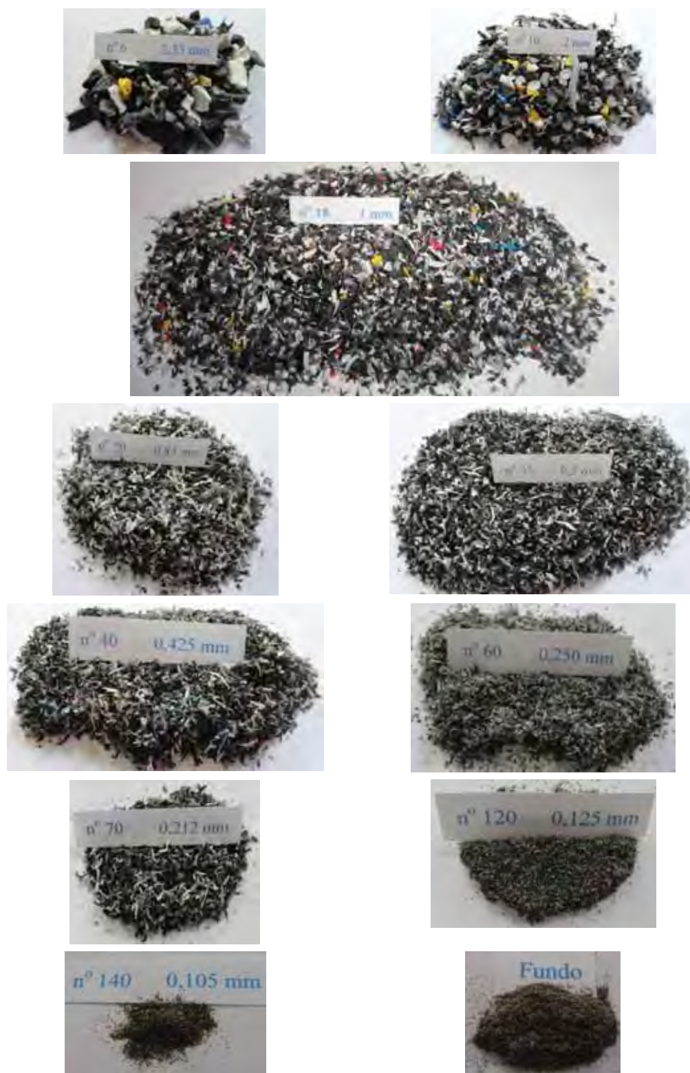
Figura 28 - Distribuição em tamanho dos resíduos termoplásticos moídos (PP, PEAD e ABS)
