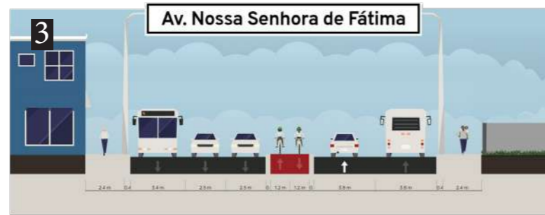
Figura 105- Corte Av. Nossa Senhora de Fátima Fonte: Autora 2023, através do site https://streetmix.net/
