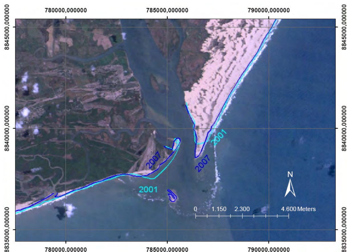
Fig. 11. Detalhe da região 1 e da região 2, em azul turquesa linha de costa em 2001 e em azul linha de costa em 2007. Sub-cena imagem TM LANDSAT 5, órbita ponto 214/67. Data: 30 de setembro de 2007. Horário: 12:22:48 GMT. Composição colorida RGB (TM, 3,2,1).
