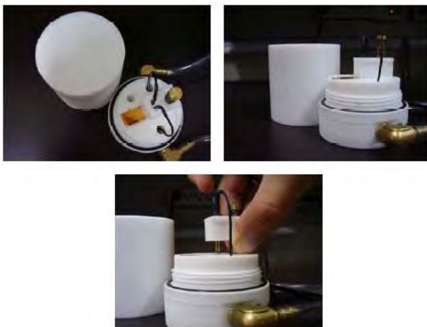
Figura 2.9: Sistema utilizado no controle da atmosfera para a realização das medidas elétricas.
