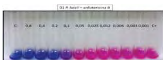
Figura 3: Teste de sensibilidade em macrodiluição empregando Alamar blue e P. lutzii . CIM de anfotericina B de 0,1 mg/L contra Pl01.
