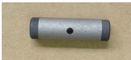
Figura 6: Tubo de grafite utilizado em GFAAS. 43
