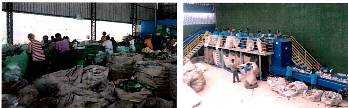
Figuras 18: a e b) Separação dos materiais da Cooperativa Cooperviva, pela plataforma e esteira de triagem.
