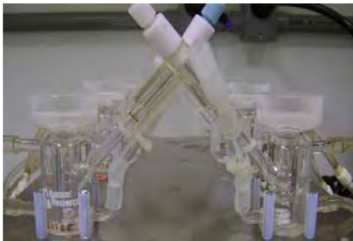
Figura 56. Fotografia do sistema de difusão composto de seis células do tipo Franz, conforme o equipamento utilizado (HANSON RESEARCH FLOWSCIENCE-POLYSCIENCE)
