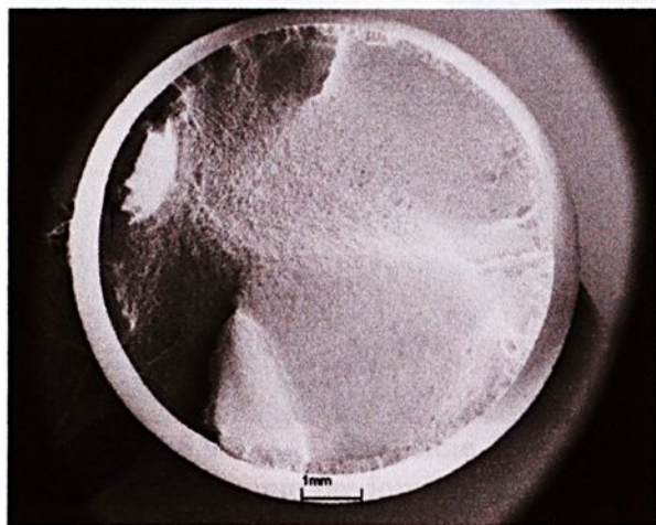
Ilustração 5.93 (108) - Superfície de fratura (cr1 - 441 MPa), com duas nucleações principais, do lado direito do cdp (25 x à esquerda, e 100 x à direita ).
