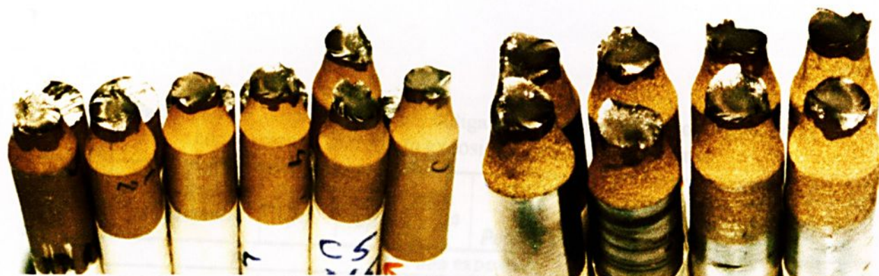
Ilustração 5.49 (64) - Superfícies de fratura dos cdps revestidos com cádmio convencional, à esquerda, e com cádmio não fragilizante, à direita.
