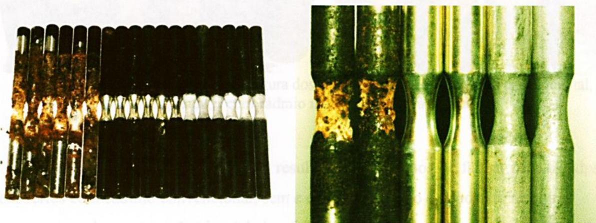
Ilustração 5.48 (63) - Aspecto dos cdps provenientes da exposição à atmosfera marítima; nas duas fotos, à esquerda, metal base; ao centro, cádmio convencional; à direita, cádmio não fragilizante.
