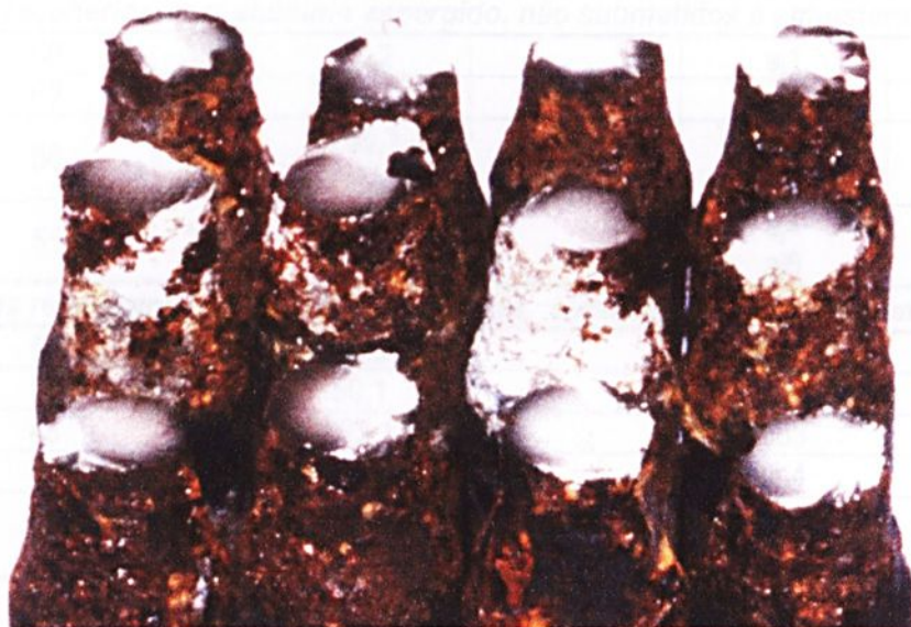
Ilustração 5.163 (178) - Superfícies de fratura dos cdp's revestidos com alumínio, após a exposição à atmosfera marítima.
