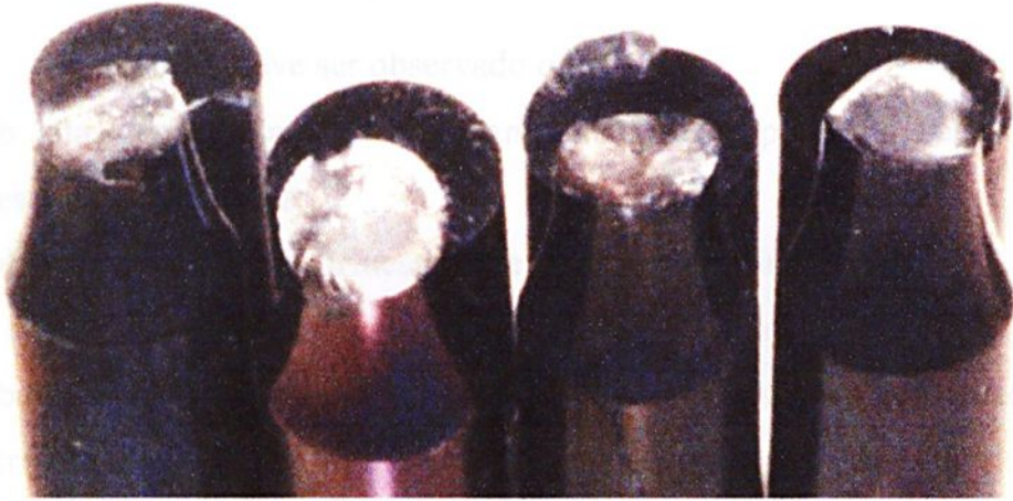
Ilustração 5.109 (124) - Superfícies de fratura dos cdps revestidos com zinco-cobalto.
