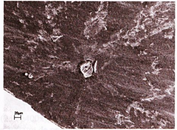
Ilustração 5.20 (35) - Cdp's B2, sob 691 MPa (25x e 500x) com inclusão a 200 \mu\text{m} de profundidade.
