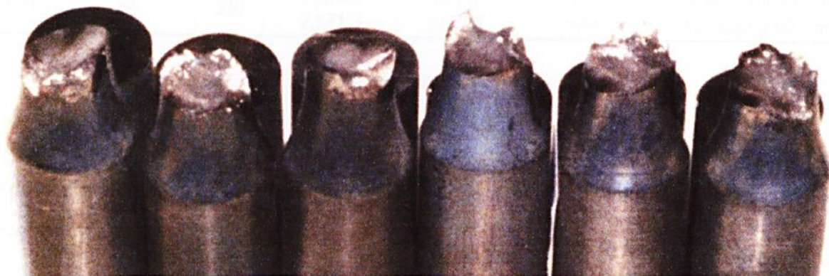
Ilustração 5.123 (138) - Superfícies de fratura dos cdps revestidos com zinco-níquel.
