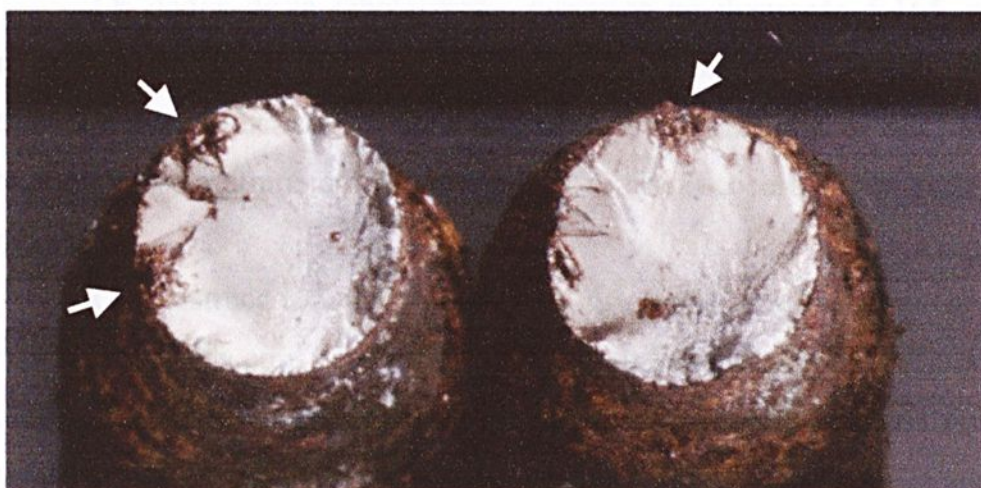
Ilustração 5.164 (179) - Detalhe da superfície de fratura de um cdp recoberto com alumínio aspergido, após a exposição à atmosfera marítima.
