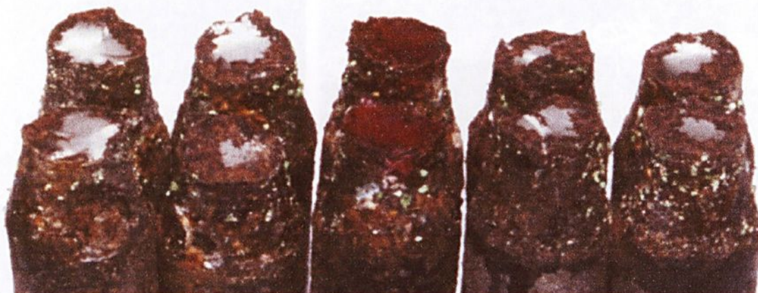
Ilustração 5.148 (163) - Superfícies de fratura dos ctps revestidos com níquel-alumínio, após a exposição à atmosfera marítima.
