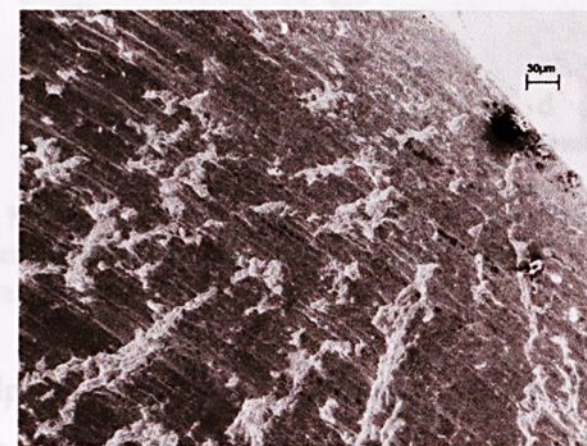
Ilustração 5.52 (67) - Cdp c2 - cádmio convencional, com inclusão na superfície (25x, à esquerda, e 500x, à direita).
