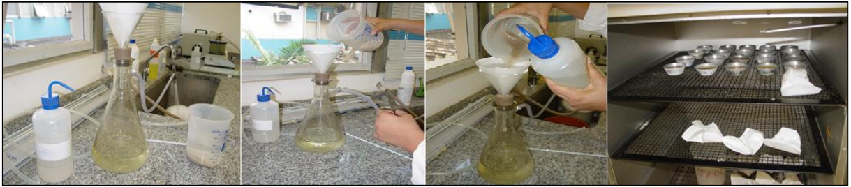
Figura 23 — Etapas de Tratamento do sedimento contendo Carbonato de Cálcio
