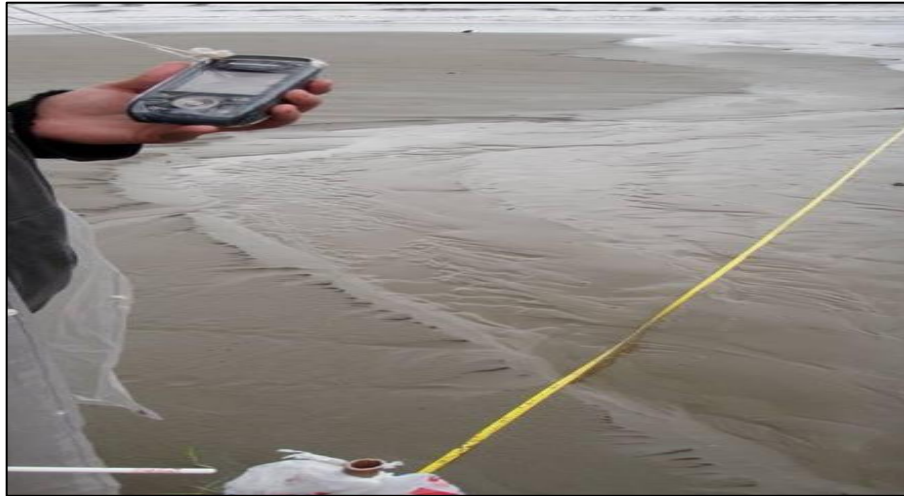
Figura 28 — Leitura do posicionamento e largura do perfil praial
