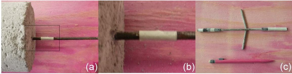
Figura 360 - CP T8-3: após arrancamento (modo de ruptura).
