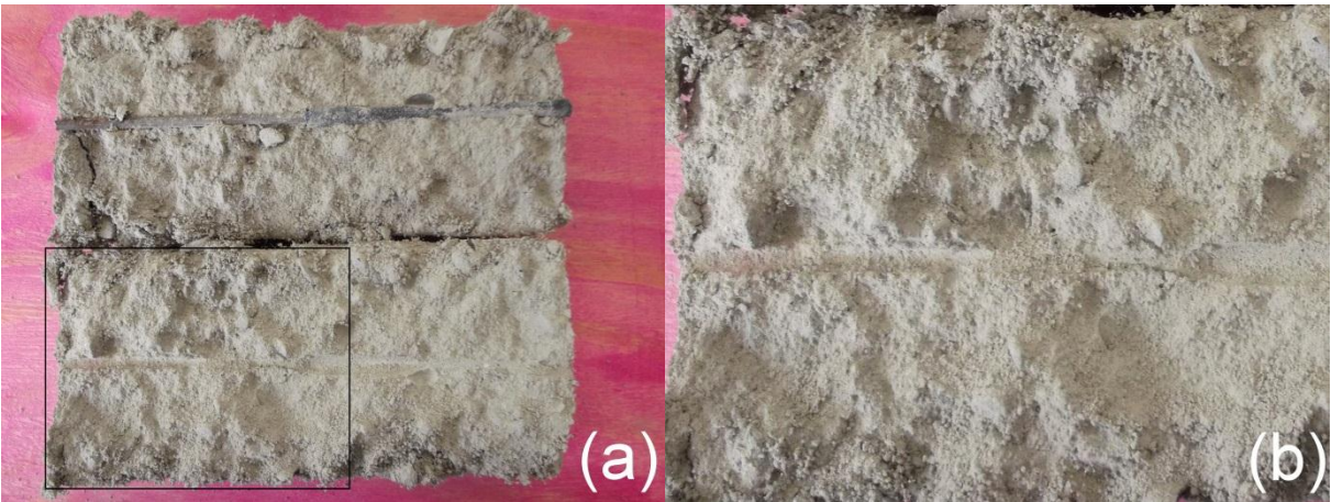
Figura 215 - CP B7-2: após arrancamento (parte interna).
