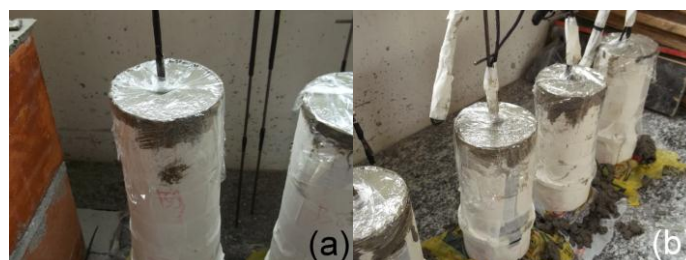
Figura 48 - Filme de plástico colocado no topo dos CPs após a moldagem.
