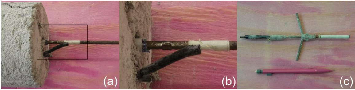
Figura 322 - CP T1-3: após arrancamento (modo de ruptura).
