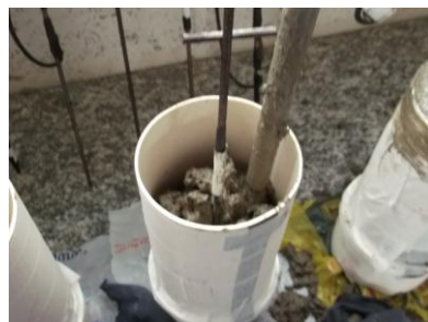
Figura 47 - Adensamento do concreto sem agente espumígeno.
