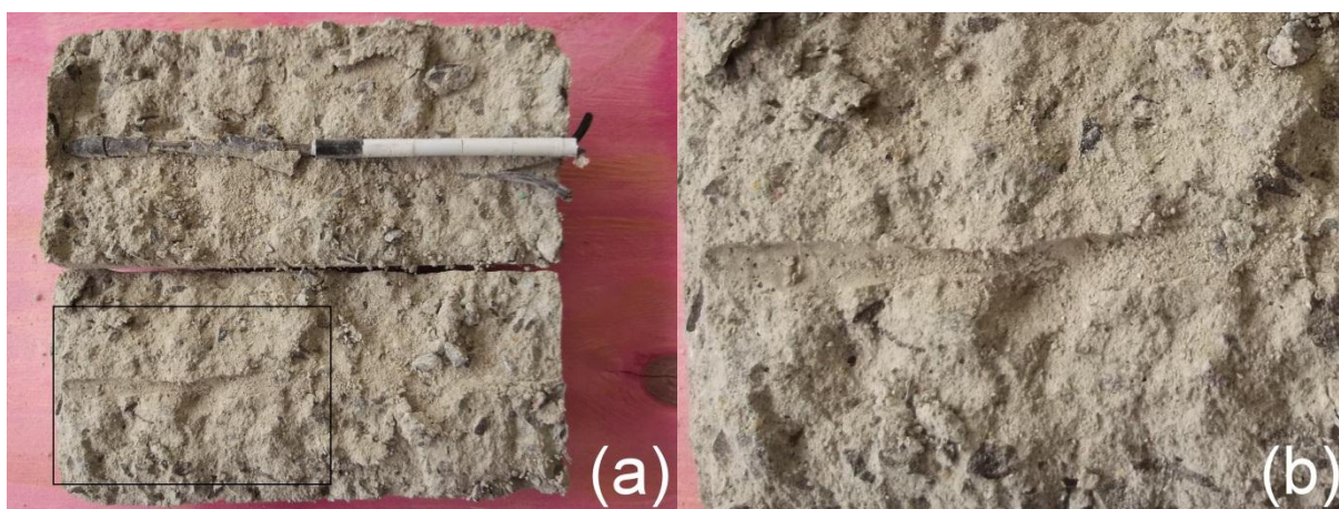
Figura 95 - CP B2-1: após arrancamento (parte interna).
