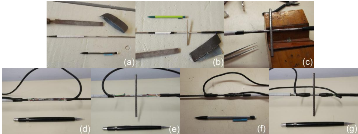
Figura 44 - Colocação dos extensômetros nas armaduras.
