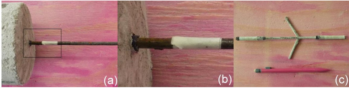
Figura 254 - CP T6-2: após arrancamento (modo de ruptura).
