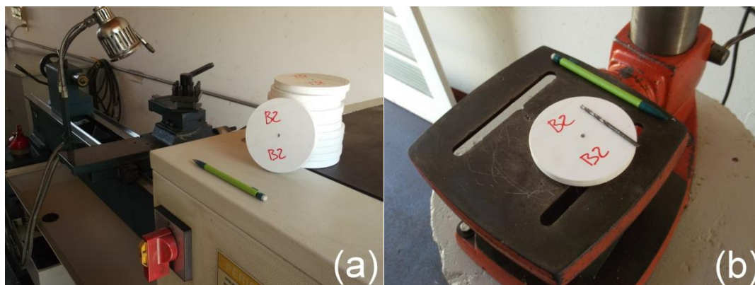
Figura 31 - Realização dos discos de PVC (a) com furo no centro (b).
