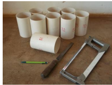
Figura 33 - Tubos de apoio utilizados para permitir a saída da armadura fora do cilindro de concreto.
