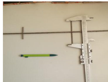
Figura 39 - Controle do comprimento das barras transversais ( t_b ).
