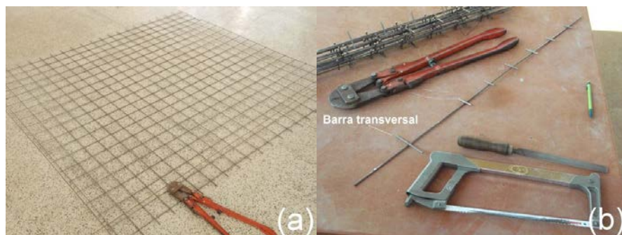
Figura 37 - Corte das armaduras para os CPs do tipo “Tela”.
