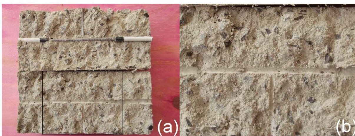
Figura 170 - CP T7-1: após arrancamento (parte interna).
