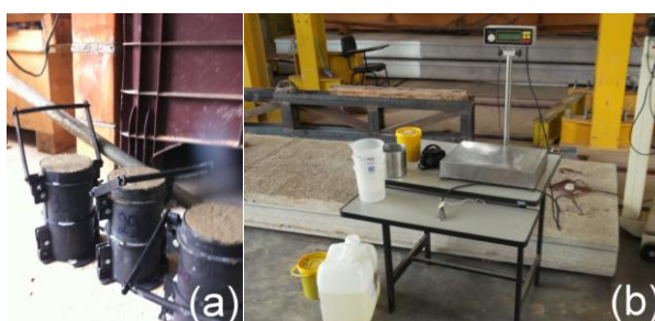
Figura 18 - Moldagem (a) e pesagem (b) do concreto para determinação dos \gamma_0 .
