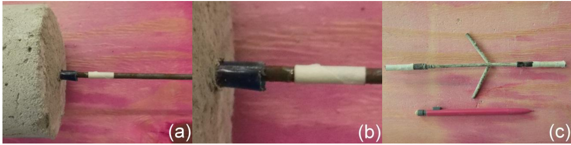
Figura 244 - CP T4-2: após arrancamento (modo de ruptura).
