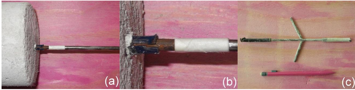
Figura 234 - CP T2-2: após arrancamento (modo de ruptura).
