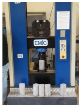
Figura 20 - Prensa universal EMIC ® utilizada para determinação de f_{cm} , E_{ci} .
