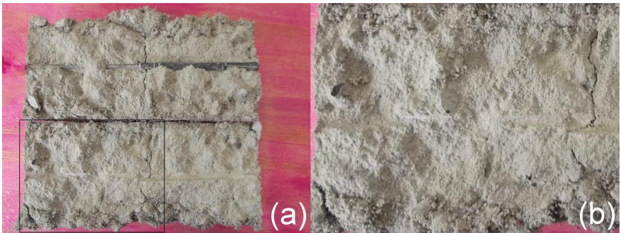
Figura 210 - CP B6-2: após arrancamento (parte interna).
