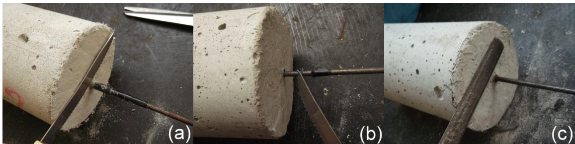
Figura 52 - Retirada da fita (a), da sobra do tubo flexível (b), lixamento do CP (c).
