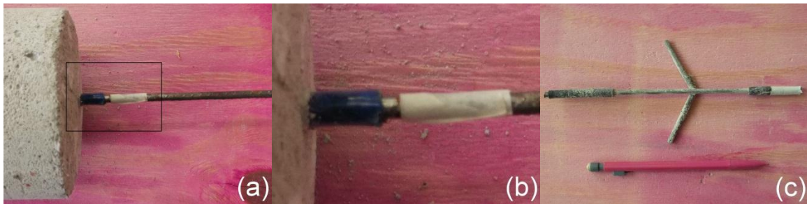
Figura 269 - CP T9-2: após arrancamento (modo de ruptura).
