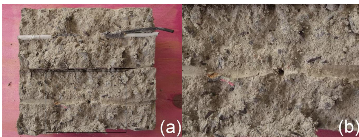
Figura 137 - CP T1-1: após arrancamento (parte interna).
