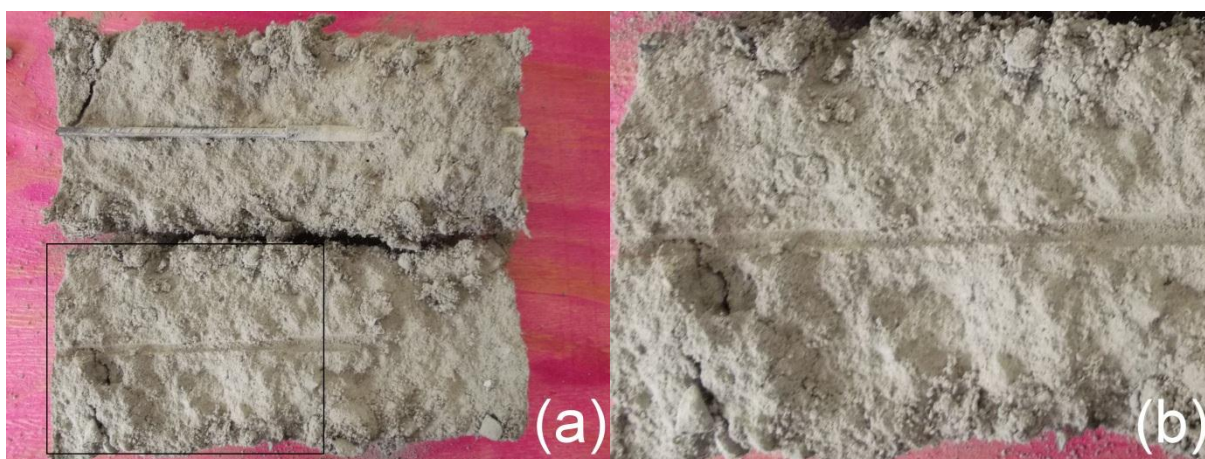
Figura 185 - CP B1-2: após arrancamento (parte interna).
