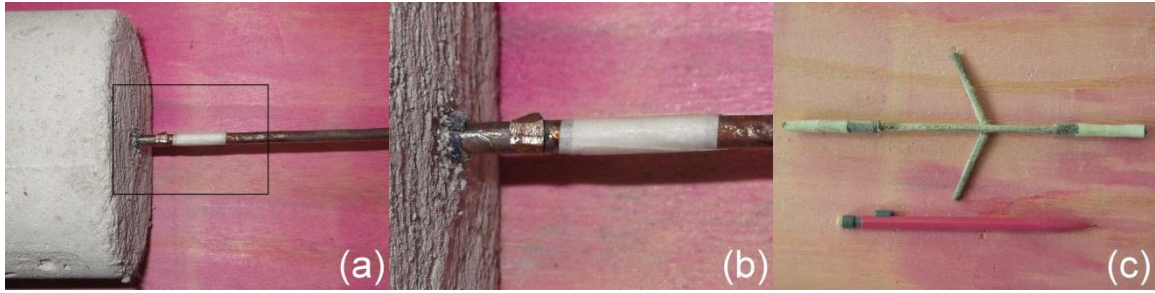
Figura 229 - CP T1-2: após arrancamento (modo de ruptura).
