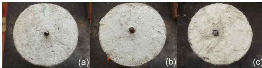
Figura 63 - Conceitos adotados para avaliação da colocação da armadura no molde: excelente (a), regular (b) e insuficiente (c).
