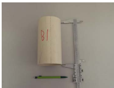
Figura 30 - Controle da altura real dos moldes com paquímetro manual.
