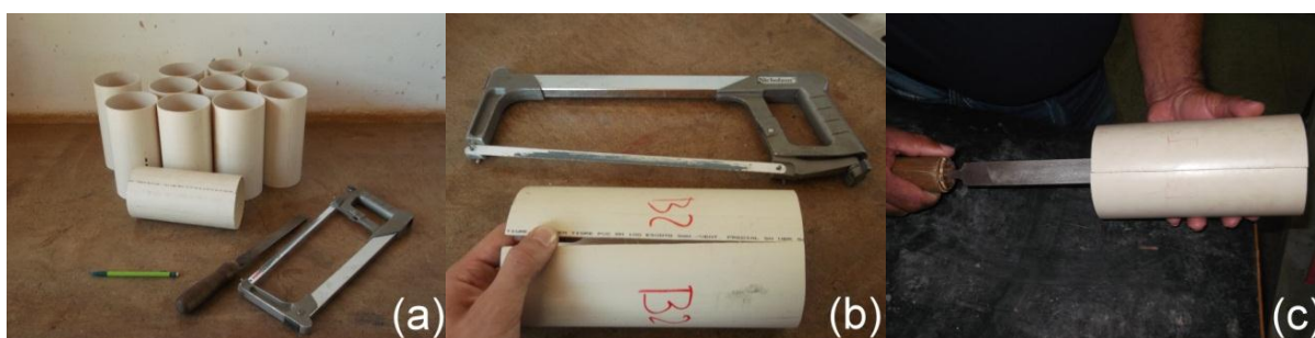
Figura 29 - Corte dos moldes cilíndricos para CPs do tipo “Barra” e “Tela”.
