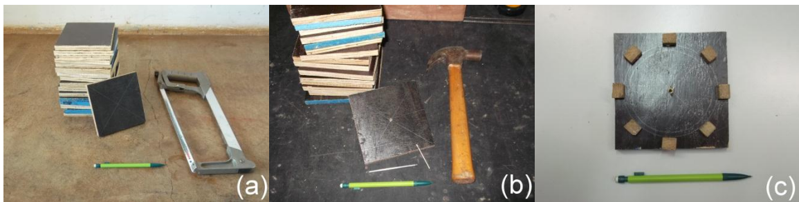
Figura 34 - Preparação das placas de madeirite.
