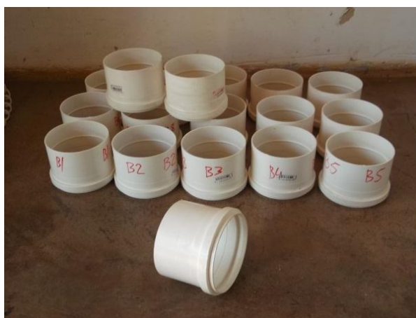
Figura 32 - Preparação das luvas para ligação das bases com os moldes.
