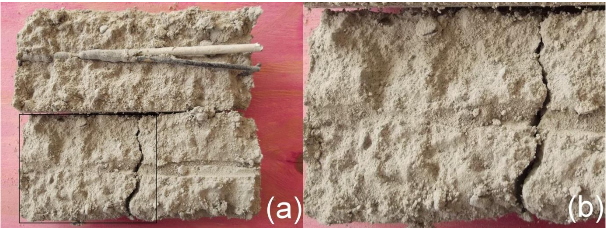
Figura 275 - CP B1-3: após arrancamento (parte interna).
