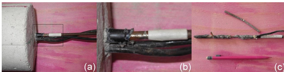
Figura 148 - CP T3-1: após arrancamento (modo de ruptura).
