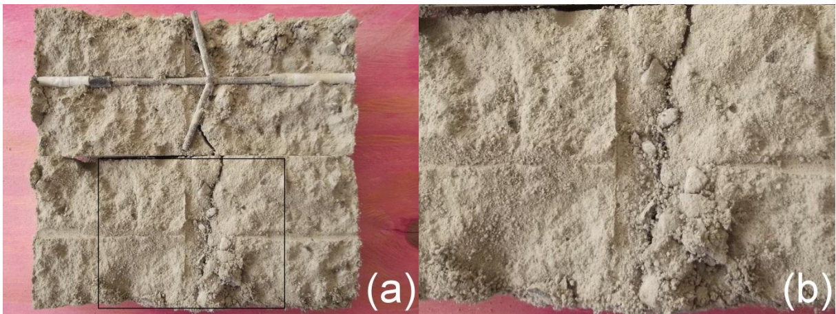
Figura 240 - CP T3-2: após arrancamento (parte interna).
