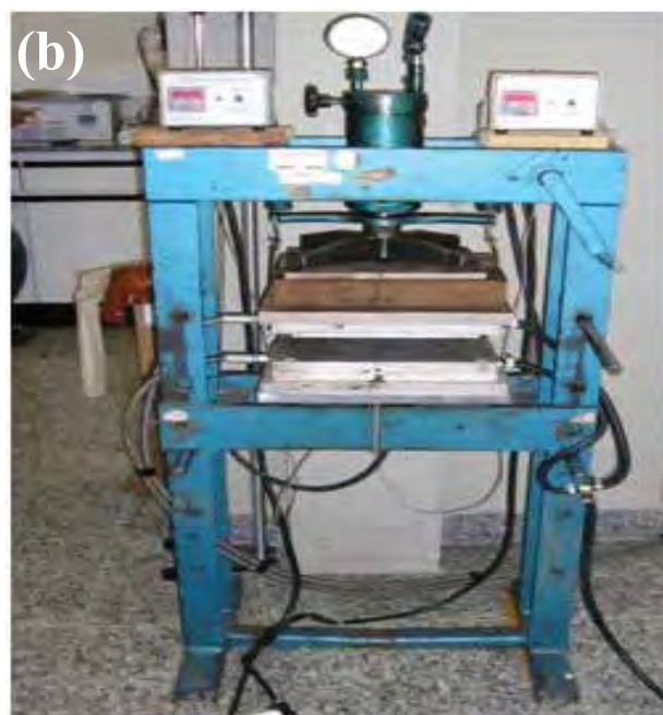
Figura 4.10. Fotografias: (a) misturador de câmara aberta da marca Makintec. (b) prensa uniaxial com sistema de aquecimento.
