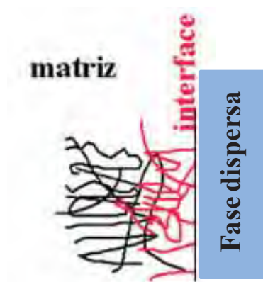
Figura 2.21. Interação interfacial entre matriz e fase dispersa.
