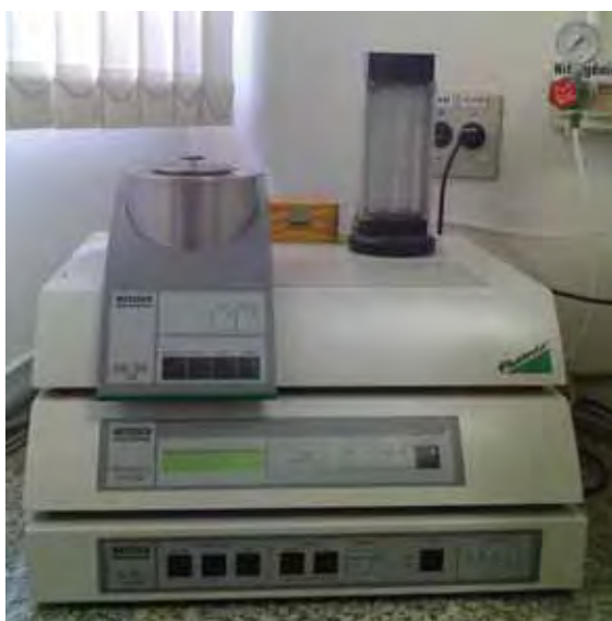
Figura 4.18. Fotografia do equipamento utilizado na análise exploratória diferencial (DSC) para o estudo dos nanocompósitos e precursor da fase NZF.
