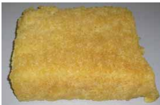
Figura 4.7. Fotografia de uma amostra de borracha seca (Crepe Claro Brasileiro) utilizada para preparação dos nanocompósitos.
