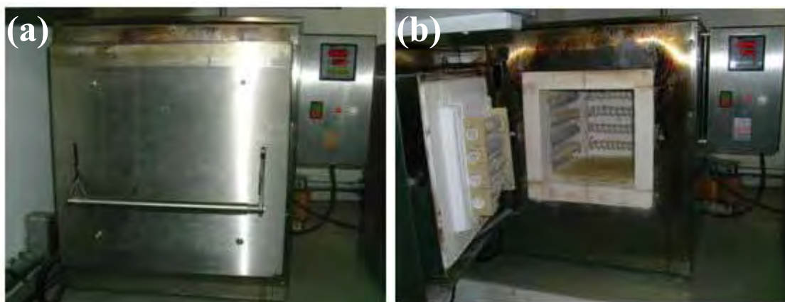
Figura 4.1. Forno utilizado para a calcinação do precursor da fase cerâmica NZF. (a) Forno fechado e (b) câmara.
