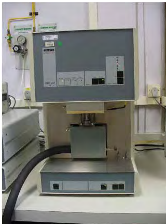
Figura 4.19. Fotografia do analisador dinâmico mecânico (DMA) utilizado para o estudo dos nanocompósitos e borracha natural vulcanizada.
