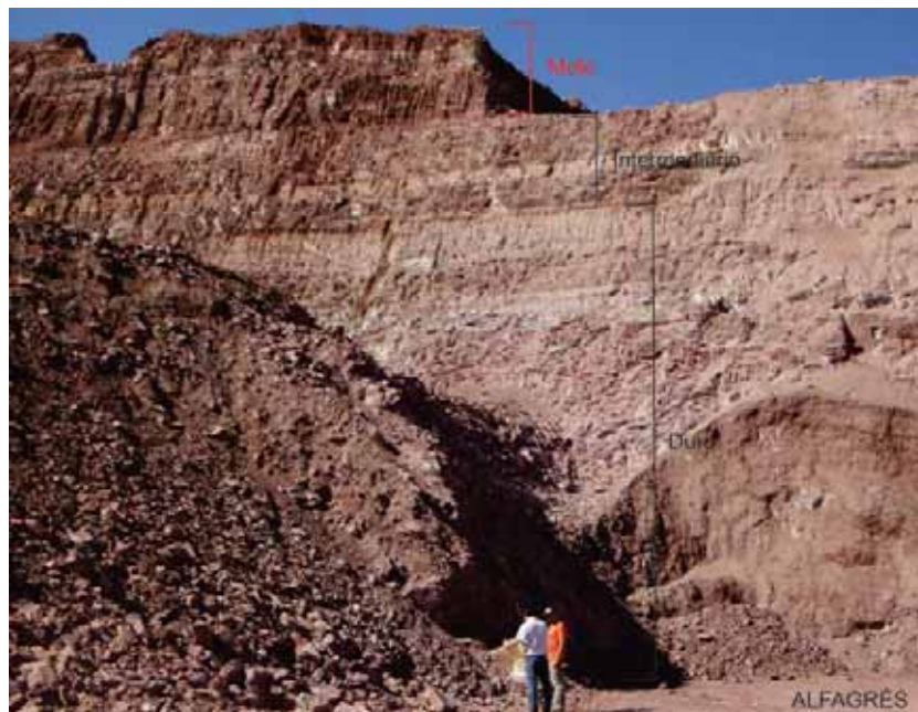
Figura 1-5 Foto mostrando os diferentes níveis da Mina Alfagrês, com destaque para os níveis intermediário e duro onde foram coletados os materiais para estudo.
