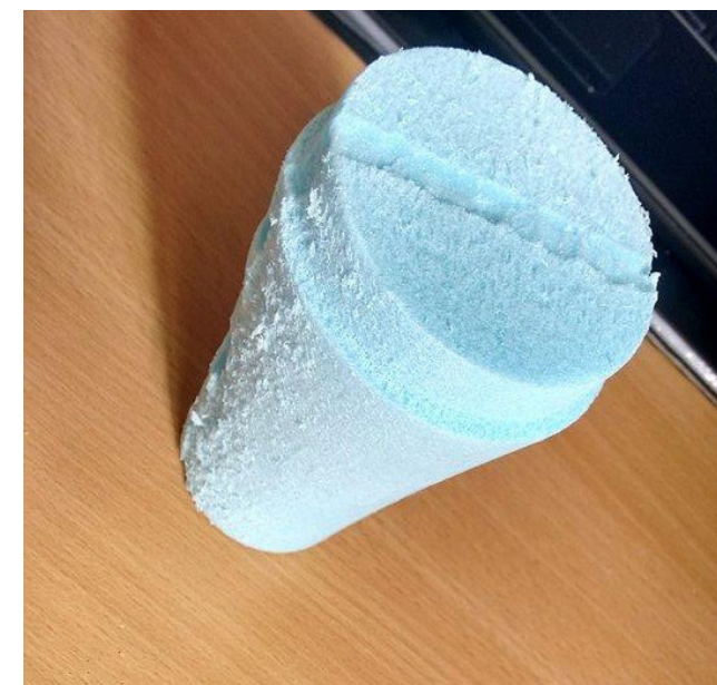
Figura 5 - Novo modelo em blue foam, houve melhora na pega e nos botões.
