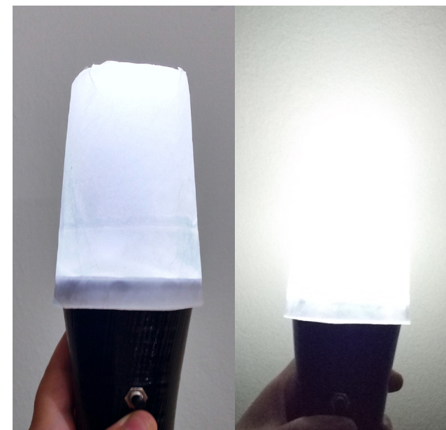
Figura 5 - Teste do copo encapado com papel manteiga com difusor de luz.
