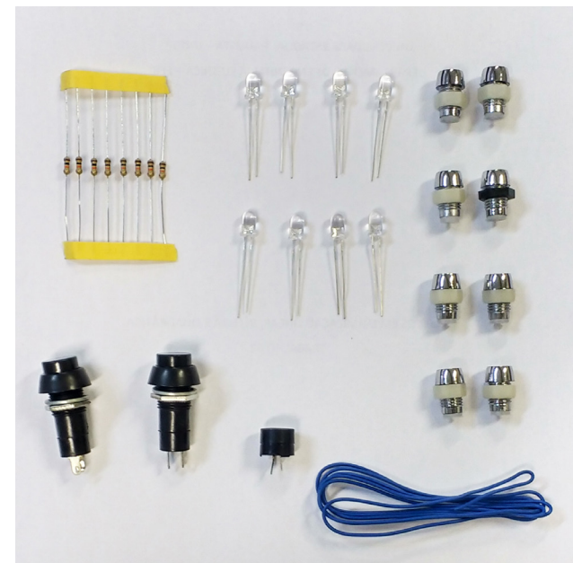
Figura 2 - Componentes elétricos utilizados (os botões foram trocados posteriormente devido a problemas de tamanho).
