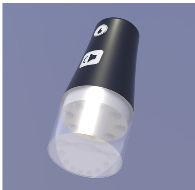
Figura 4 - Modelo em SolidWorks, montagem com o difusor de luz.
