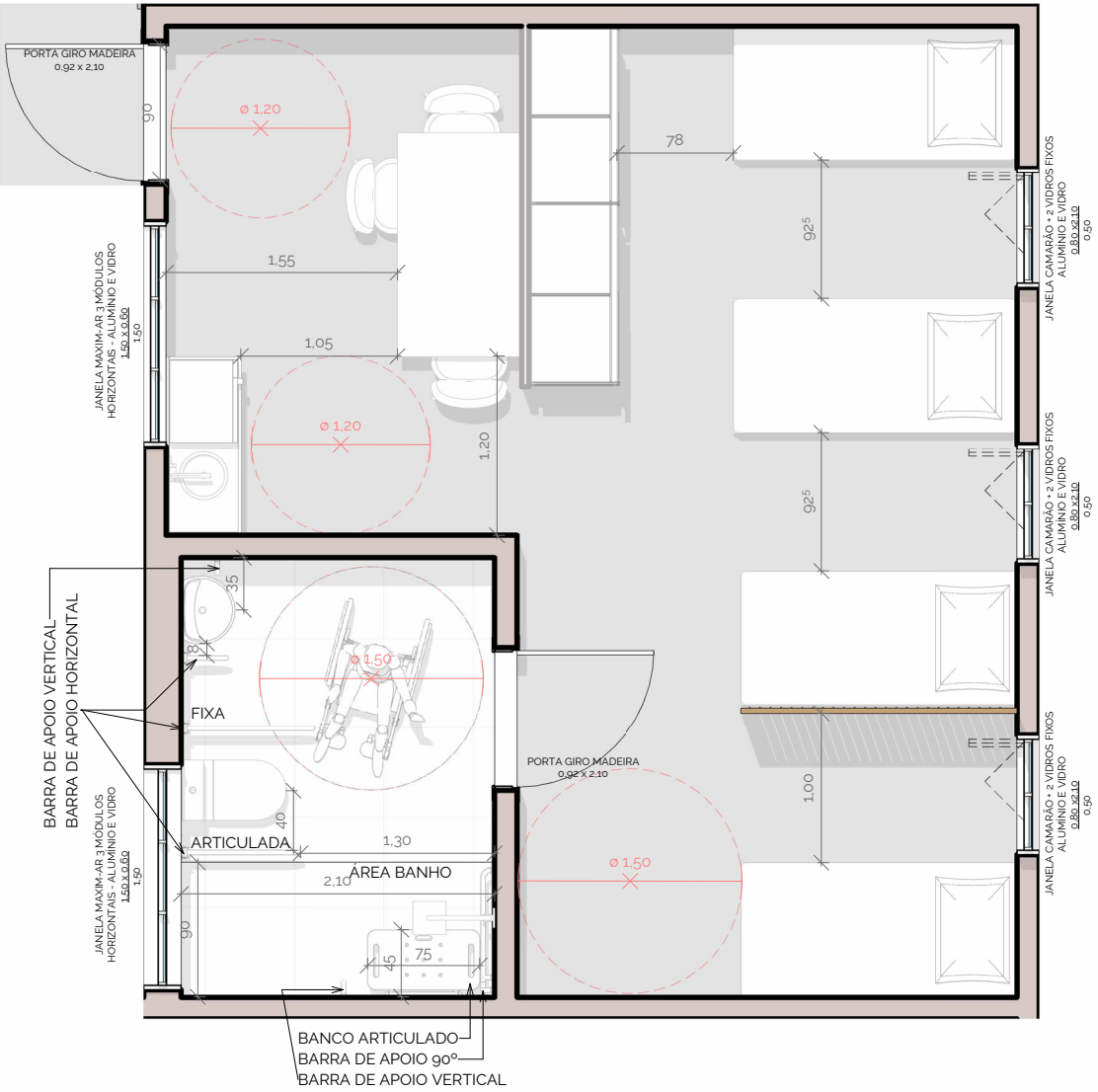
MÓDULO DORMITÓRIO 4 PESSOAS - ADAPTADO PCR Escala 1:50
