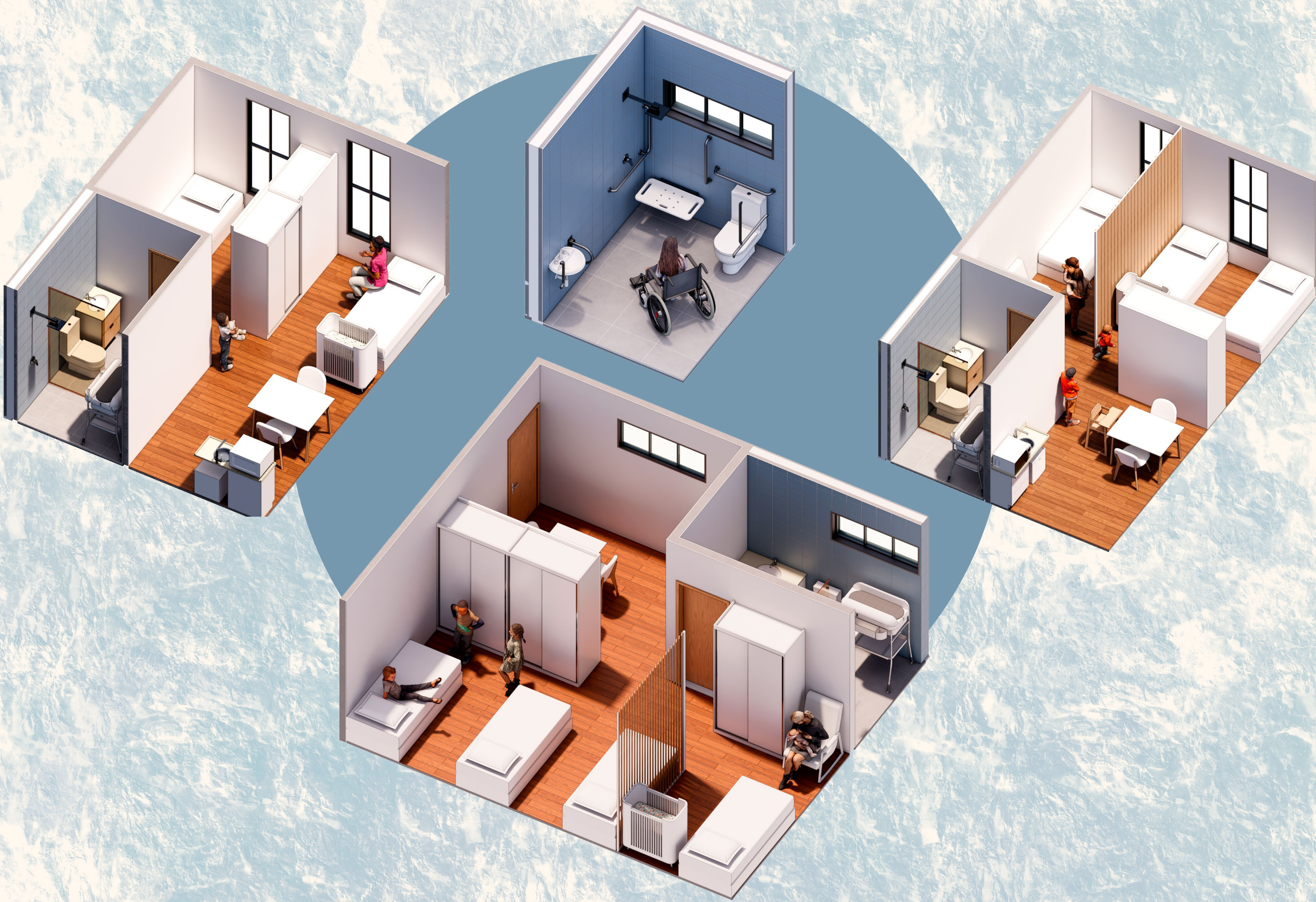
Figura 80 - Perspectiva 3D dos módulos de dormitórios de 2, 3 e 4 pessoas, com exemplo de banheiro adaptado para PCR. Fonte: Autora, 2024.
