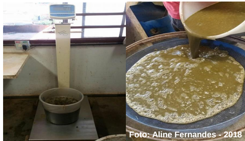
Figura 1- Pesagem, homogeneização e peneiramento do substrato
