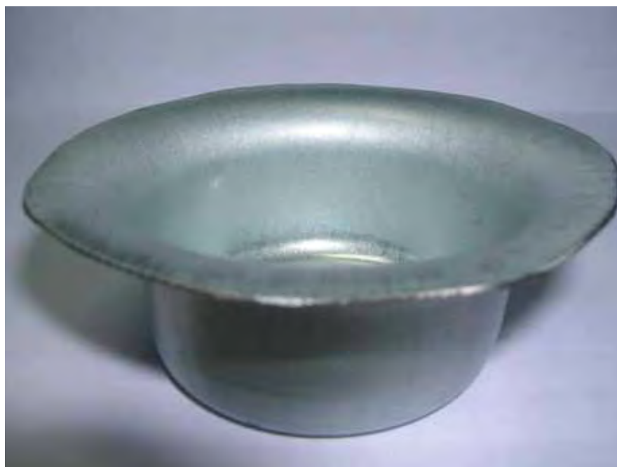
Figura 5.6 – Peça estampada no ensaio.
