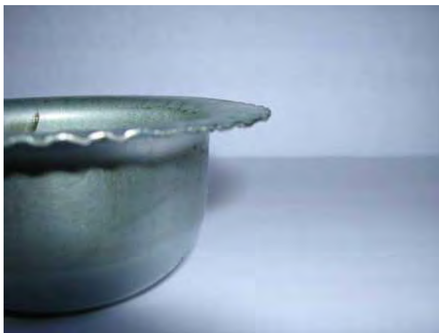
Figura 5.28 – Defeito de enrugamento ocorrido durante o ensaio.
