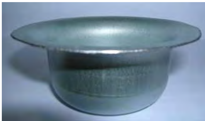
Figura 5.2 – Peça estampada no ensaio.
