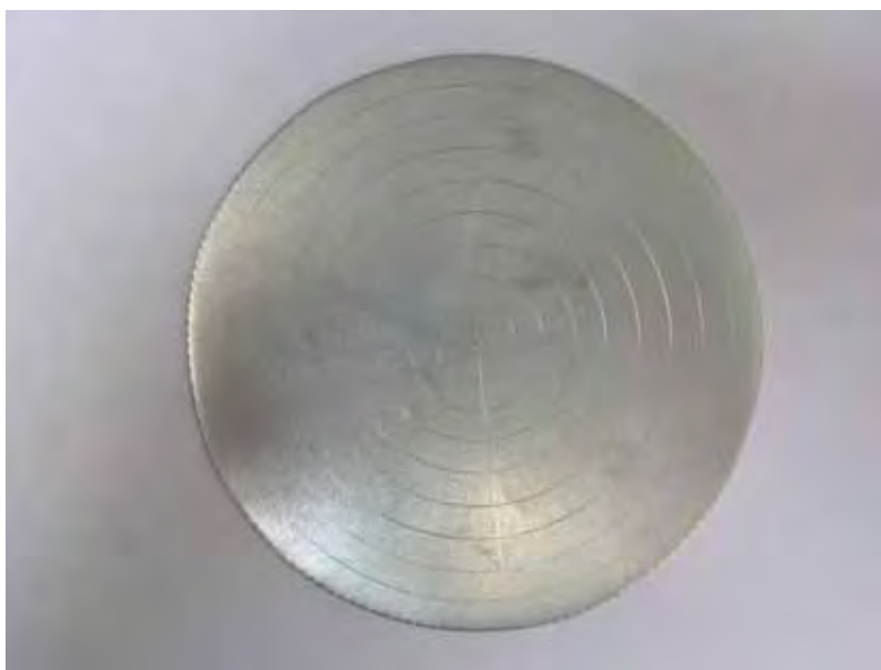
Figura 3.6 – Blank com as marcações.
