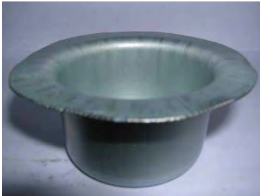
Figura 5.10 – Peça estampada no ensaio.
