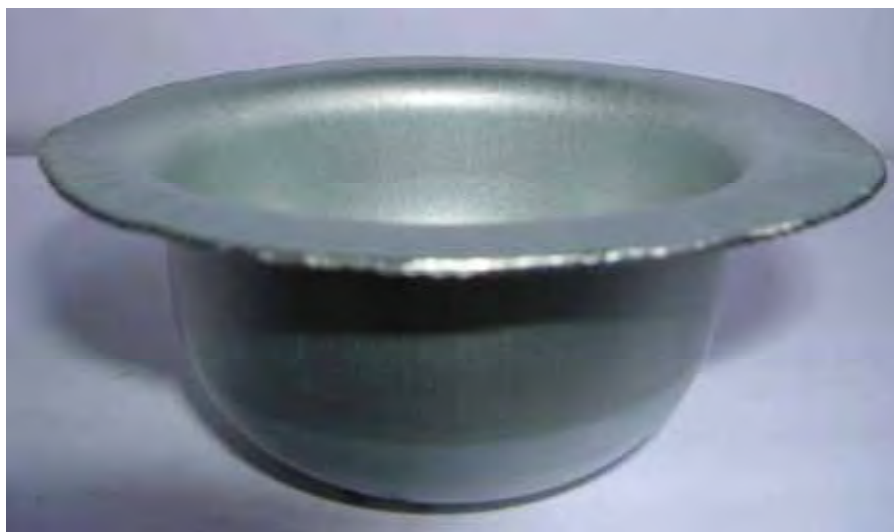
Figura 5.24 – Peça estampada no ensaio.
