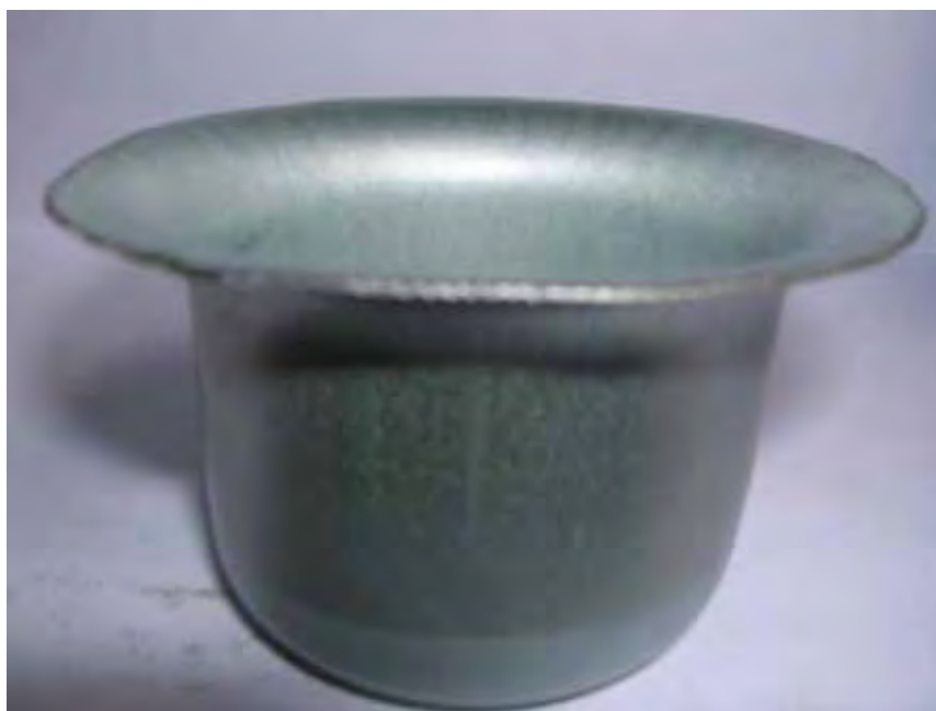
Figura 5.16 – Peça estampada no ensaio.
