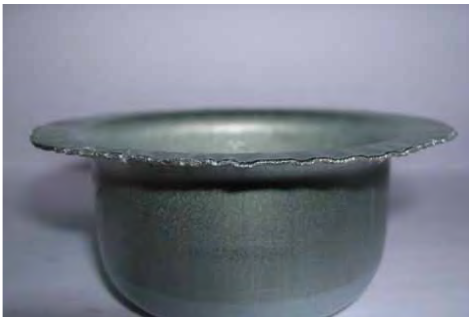
Figura 5.20 – Peça estampada no ensaio.
